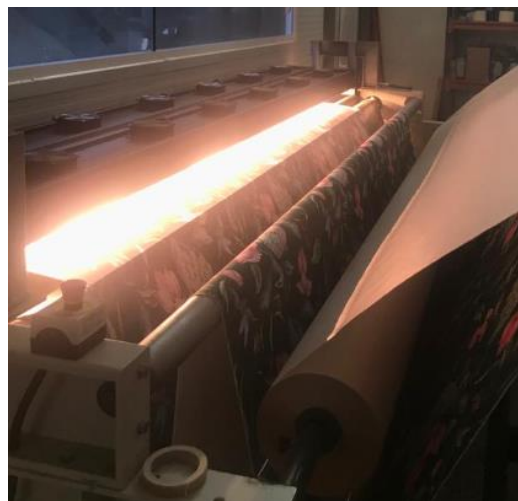
Fig. 39 Proceso de presecado con rayos infrarrojos.
