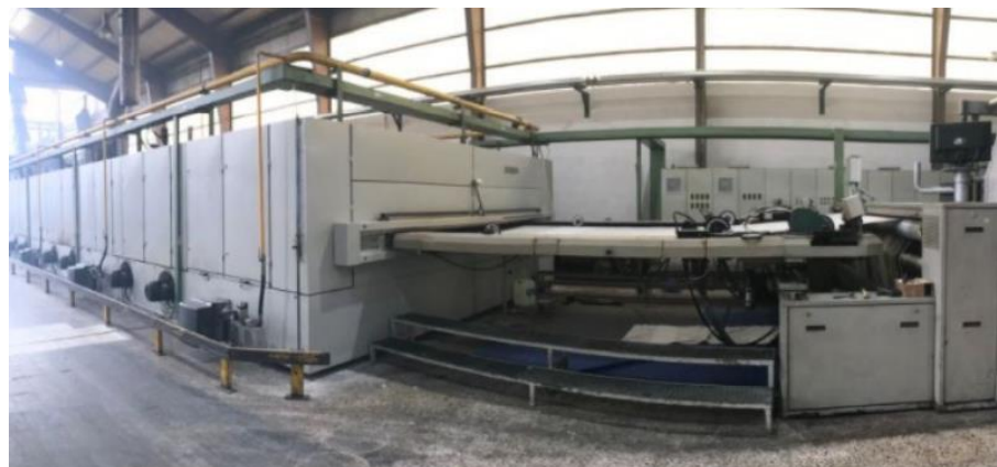
Fig. 33 Rame para el proceso de termofijado.
