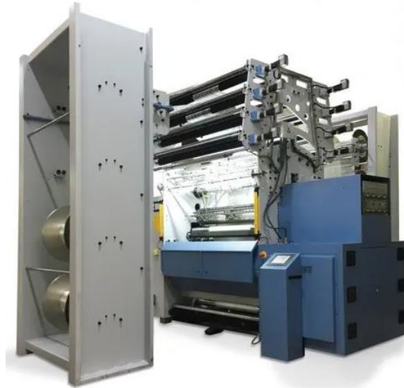
Fig. 26 Telar de punto por urdimbre de tipo Raschel de doble fontura.
