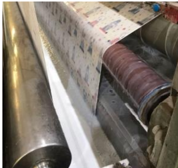
Fig. 51 Foulardado producto antibacteriano e ignífugo.
