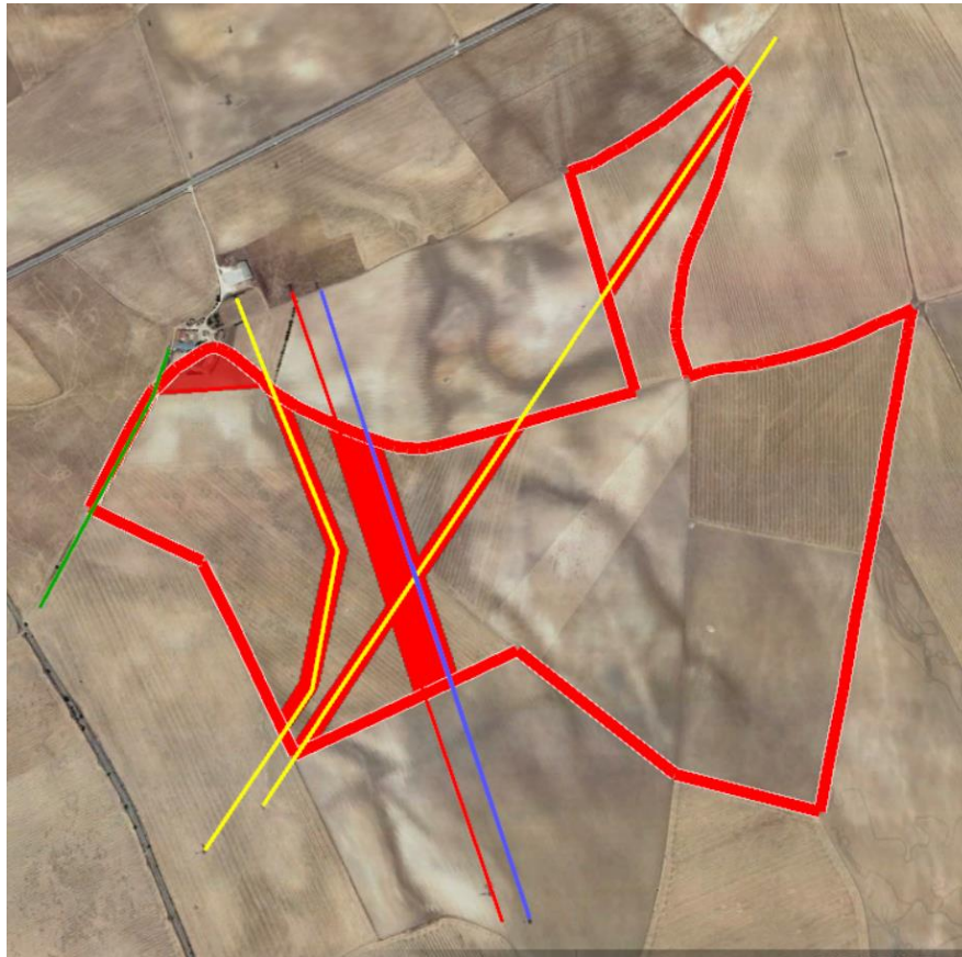
Imagen 17. Afecciones provocadas por líneas eléctricas y retranqueos [1]
