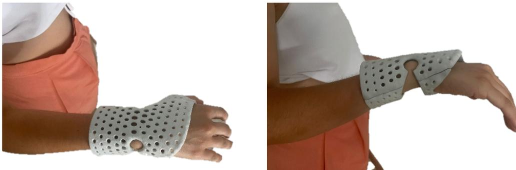
*Figura 5.9. Prototipo 1 de la órtesis de mano impreso en PA12 colocado en la mano del paciente.*
