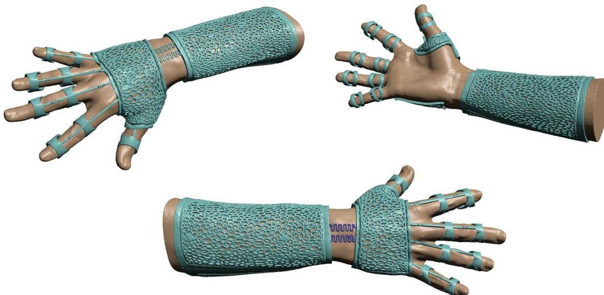
*Figura 4.2. Diferentes vistas 3D del diseño preliminar 1 de la órtesis. (Fuente: Elaboración propia)*
