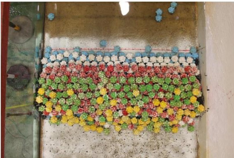
Figura 29: Inicio de Avería Fuente: Lozano (2021)-LPCUPV
