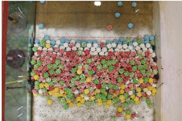
Figura 30: Destrucción de la estructura.
