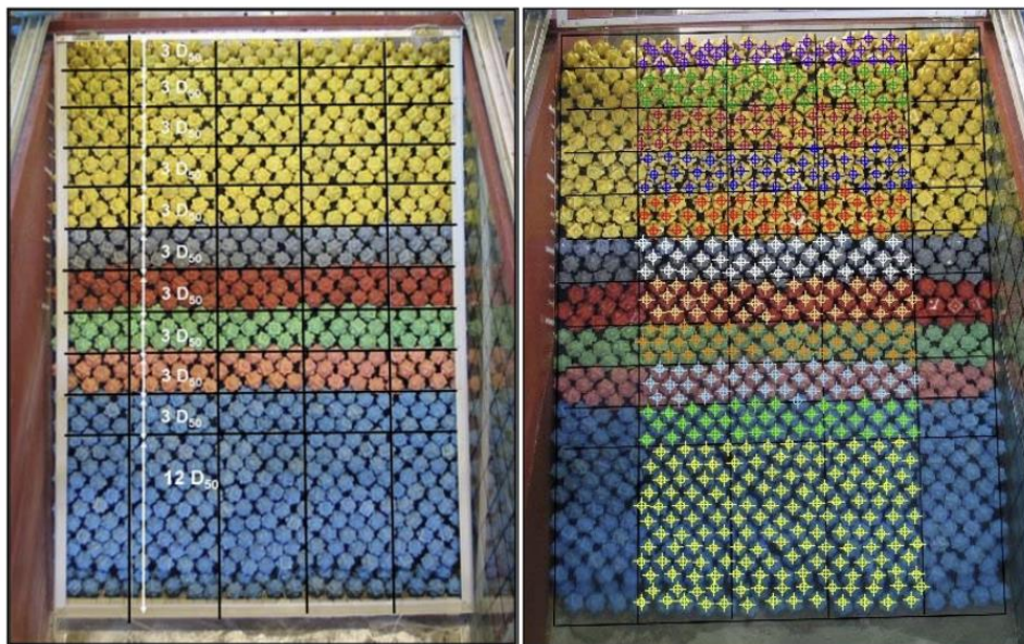
Figura 31: Fotografías perpendiculares al talud del manto bicapa de Cubipodos: (1) con marco de referencia y Malla Virtual, y (2) sin marco de referencia, con Malla Virtual y conteo de unidades en cada banda ( N_i ). Fuente: Gómez-Martín (2015)
