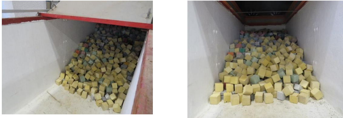
Figura 37: Talud dissipador de energ a.
