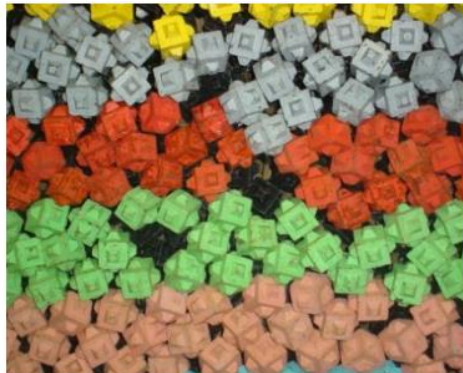
Figura 24: Ejemplo de IA en manto bicapa de Cubípodos.
