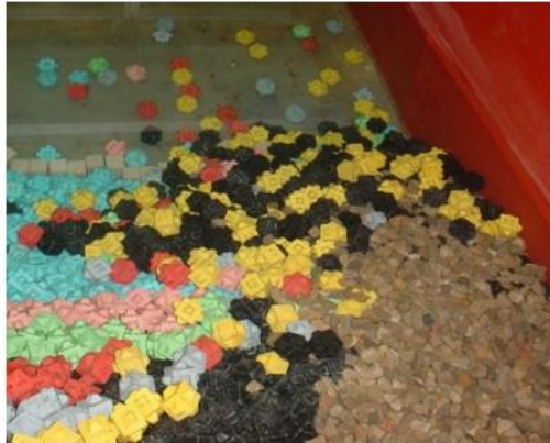
Figura 27: Ejemplo de D en manto bicapa de Cubípodos.
