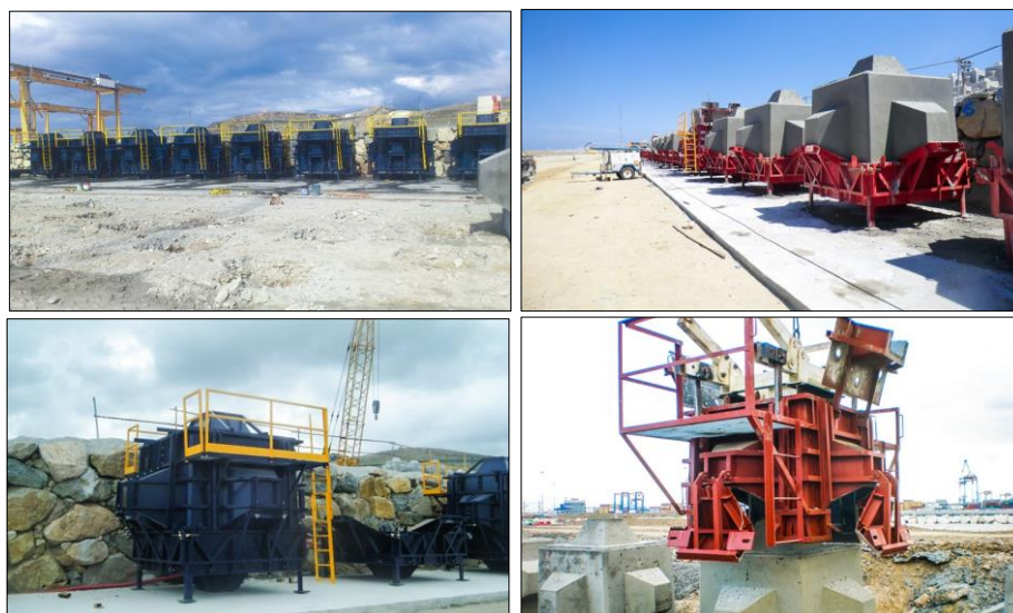
Figura 100: Encofrado del Cubípodo.
