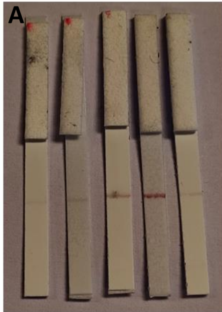
Figura 18. Medida de la intensidad de señal exponencial en las tiras reactivas. A: Imagen de las tiras en las que se observa la creciente intensidad, excepto en la última, esto es debido al “hook effect”. B: Representación gráfica de la señal de reconocimiento utilizando las cinco tiras para observar el “hook effect”.
