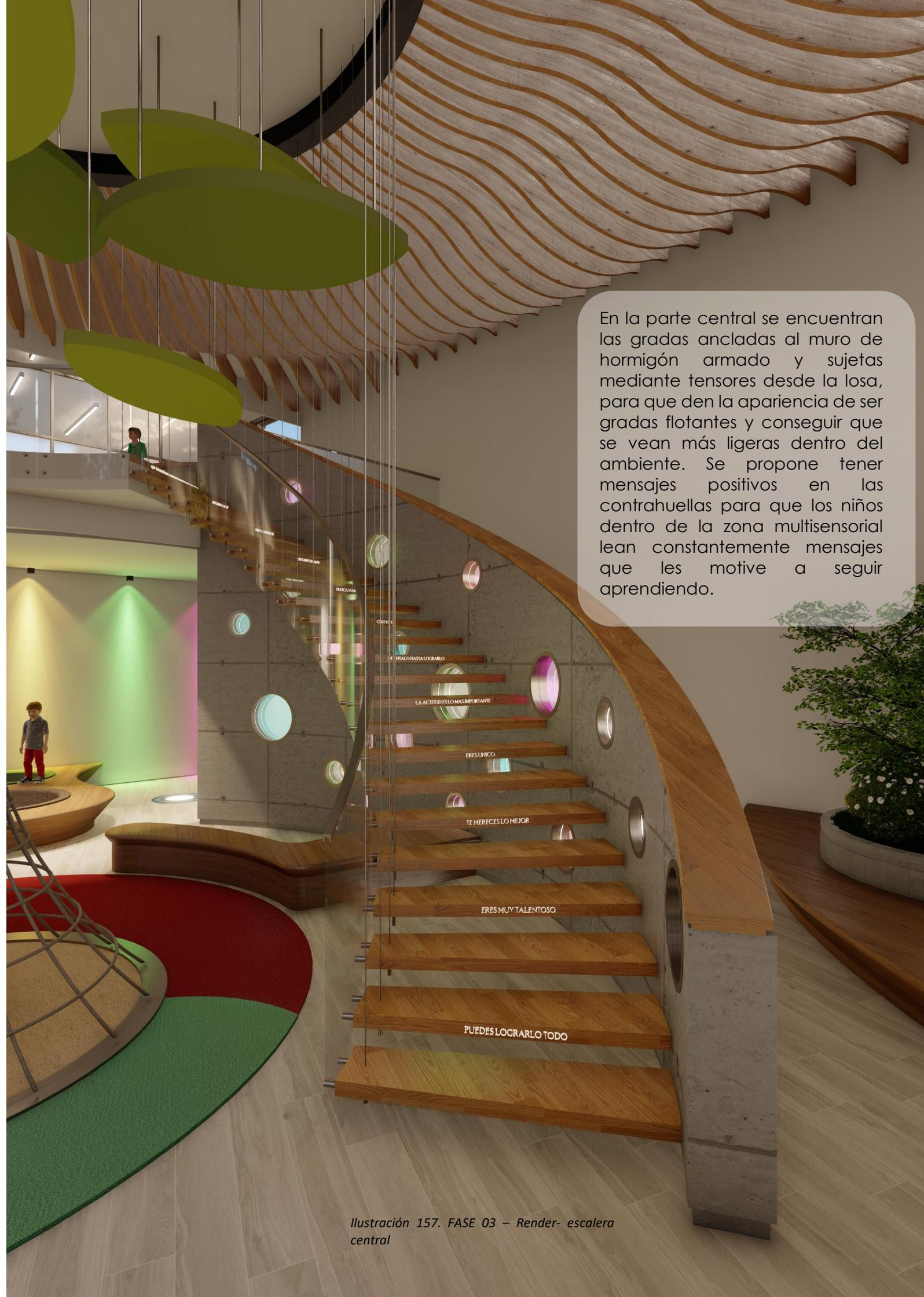
En la parte central se encuentran las gradas ancladas al muro de hormigón armado y sujetas mediante tensores desde la losa, para que den la apariencia de ser gradas flotantes y conseguir que se vean más ligeras dentro del ambiente. Se propone tener mensajes positivos en las contrahuellas para que los niños dentro de la zona multisensorial lean constantemente mensajes que les motive a seguir aprendiendo.
