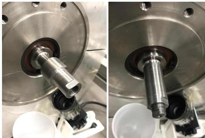
Figura 8. Pin pasador usado para cada ensayo. Diámetro izquierdo 22,2 mm y diámetro derecha 15,9 mm.
