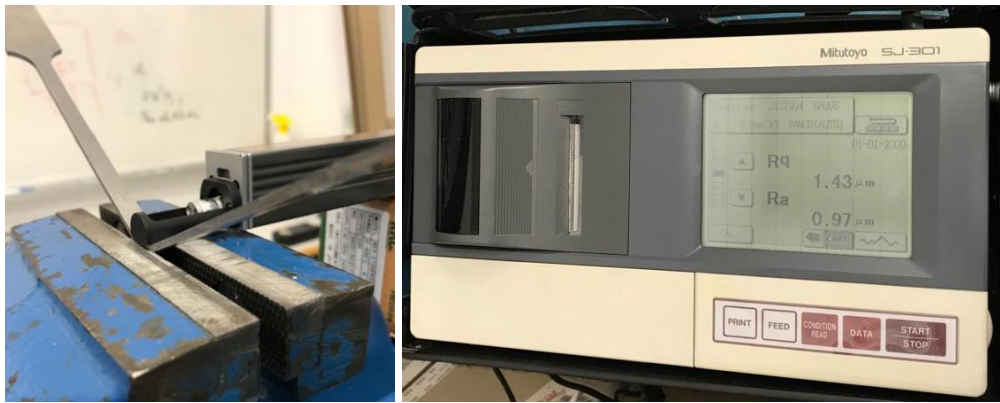
Figura 16. Toma de medida rugosidad / Lectura rugosímetro
