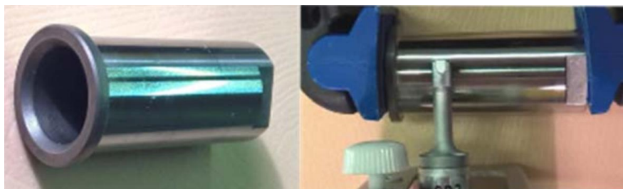
Figura 18. Toma medida rugosidad en pin
