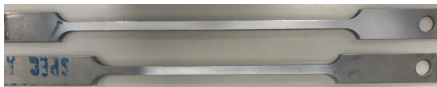
Figura 19. Probetas aleación de titanio SP-700 utilizadas para ensayo de tracción.
