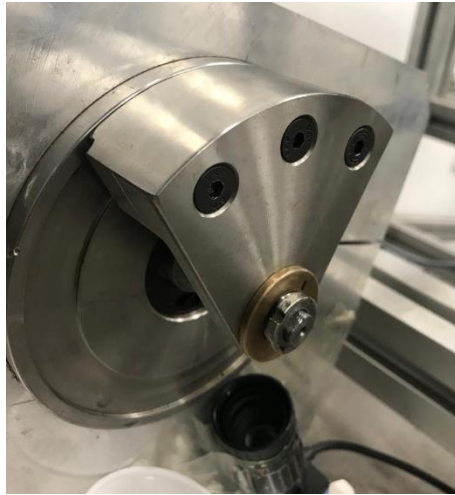
Figura 9. Finalización del montaje de cada pin pasador
