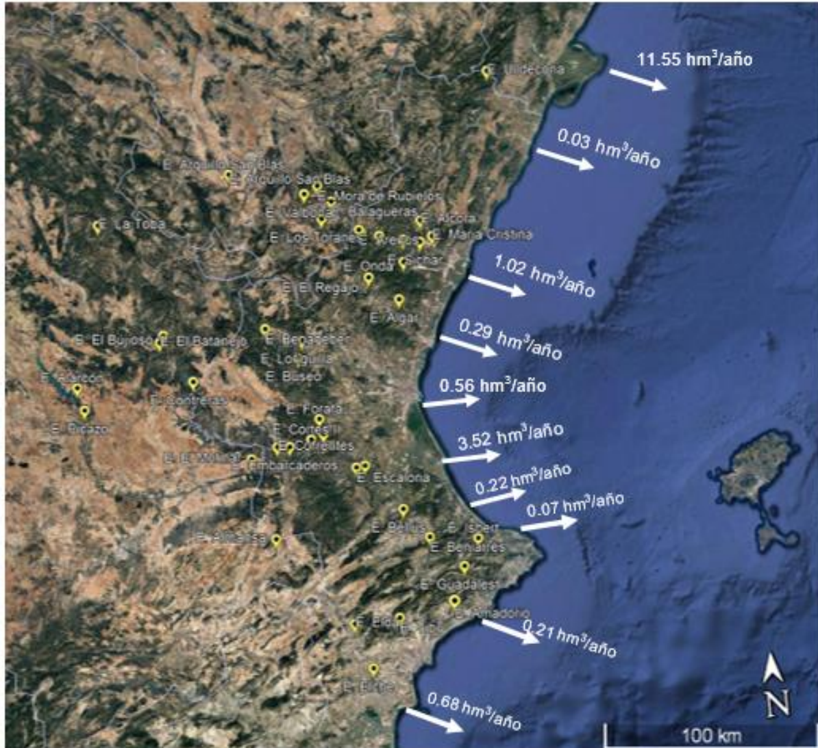
Figura 43. Pérdida de volumen de sedimento anual en la costa valenciana (fuente: Google Earth)
