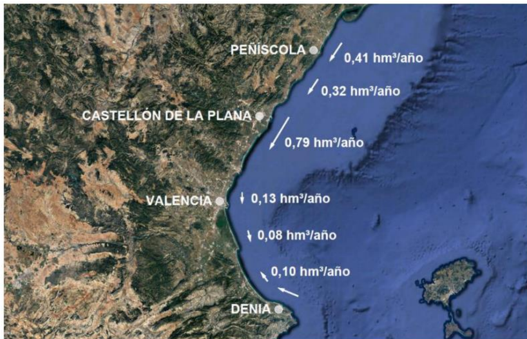
Figura 22. Estimación de la capacidad de transporte longitudinal de sedimentos (Alguacil, 2020)
