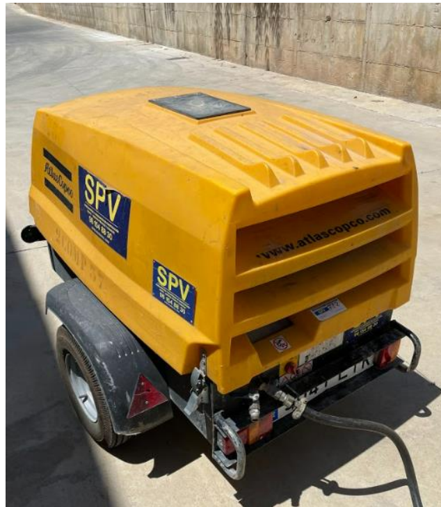
Figura 4.15. Compresor: Fuente de alimentación del aire a presión (conectada al calderín)
