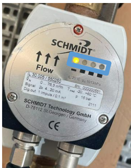
Figura 4.4. Luces LEDs que marcan el estado del sensor
