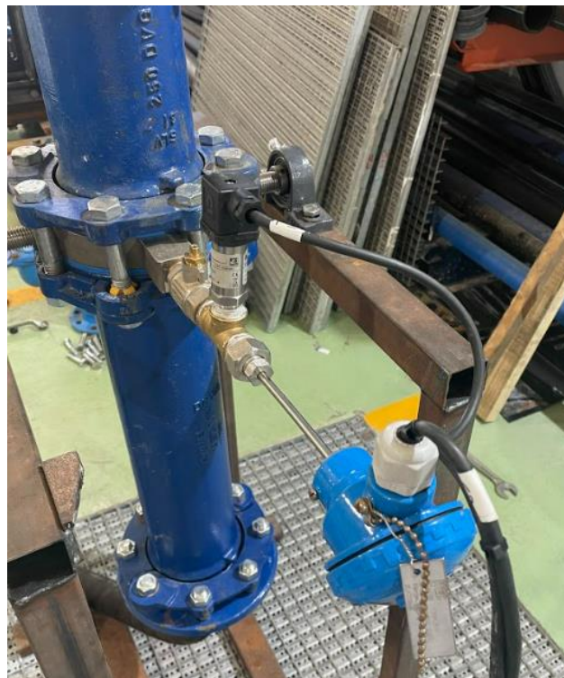
Figura 4.16. Sensor cerámico midiendo la presión en el purgador
