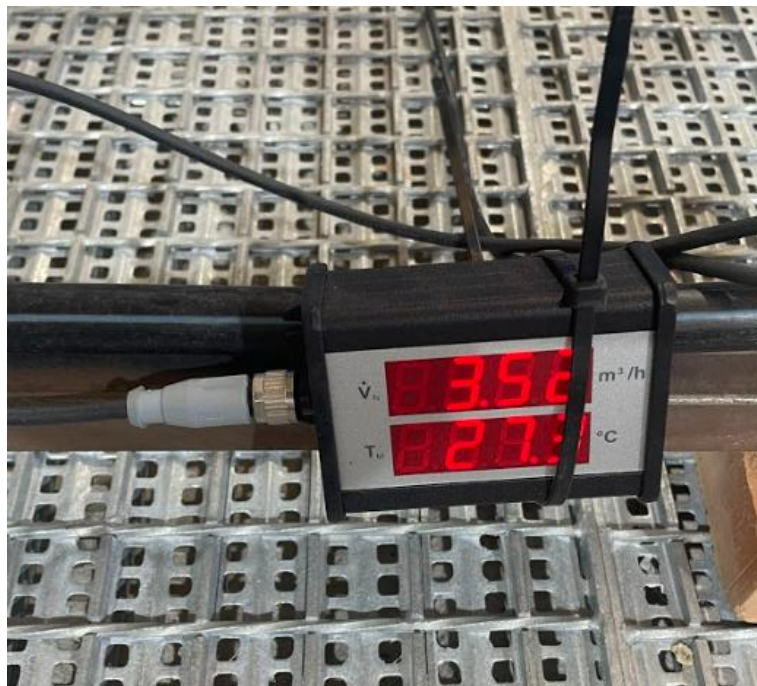
Figura 4.18. Lector de valores mostrando el caudal y la temperatura presentes en el purgador
