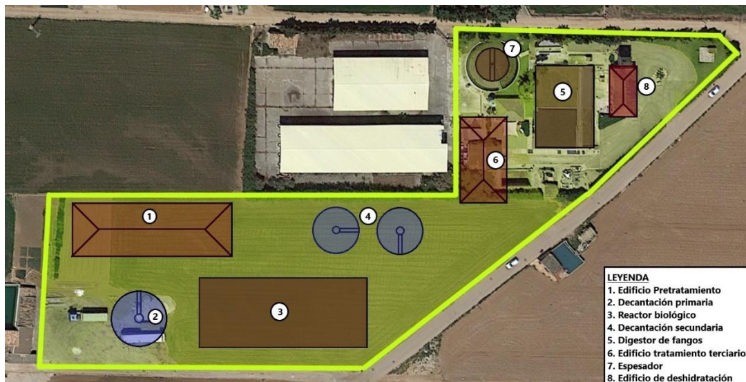
Figura 36. Esquema básico aproximado del diseño de la nueva EDAR Sa Pobra.
