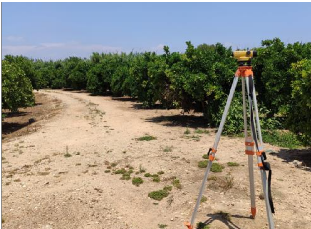
Foto 11 Obtención de cotas de zona de actuación mediante nivel óptico. La Pobra Llarga
