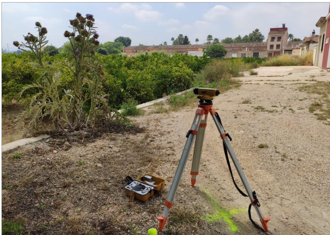
Foto 9 Obtención de cotas de zona de actuación mediante nivel óptico. La Pobla Llarga
