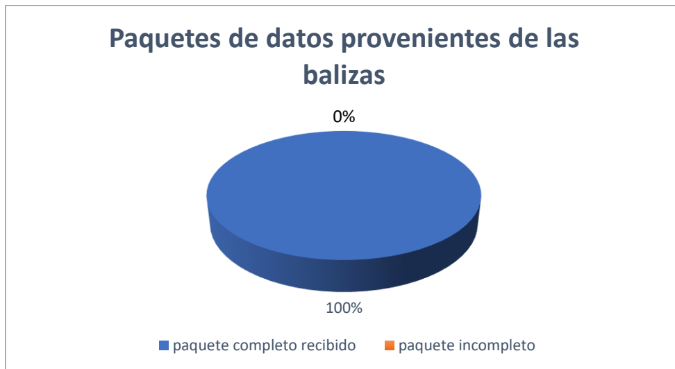
Figura 63. Pérdida de datos del sistema de balizas con T=0,2s .
