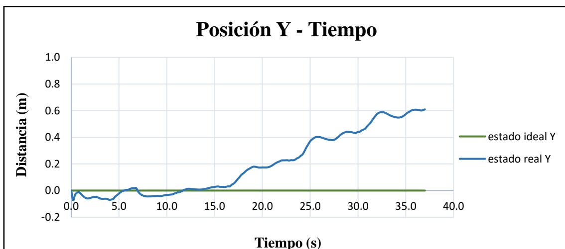
Figura 62. Seguimiento de la posición en Y-tiempo con EKF y T=0,2s .
