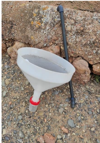
Figura 1. Embudo y vara utilizados en el método de muestreo por golpeo.
