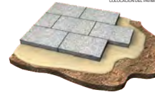
COLOCACIÓN DEL PAVIMENTO
