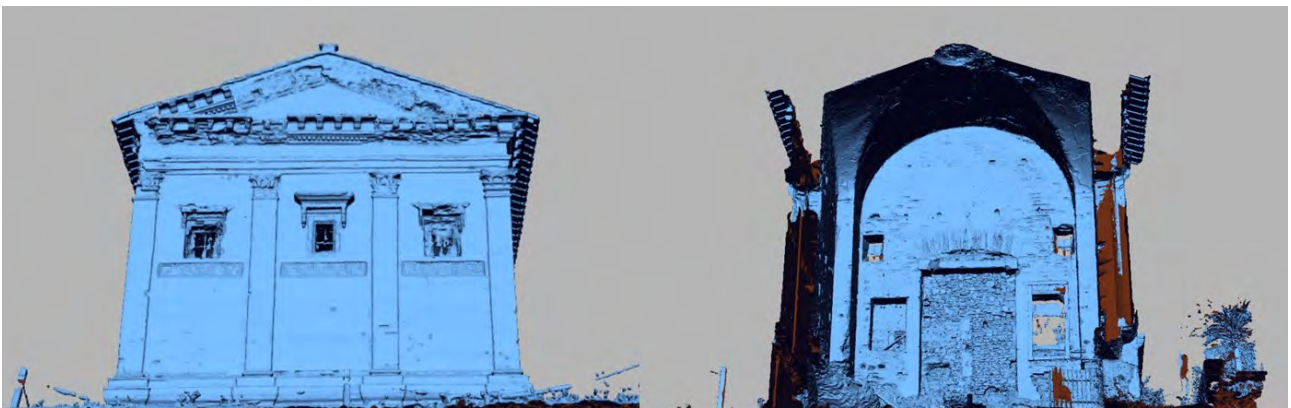
Fig. 39b - El Mausoleo di Annia Regilla (fachada y sección): creación de la mesh con el software Geomagic© (Fuente: Autor).
