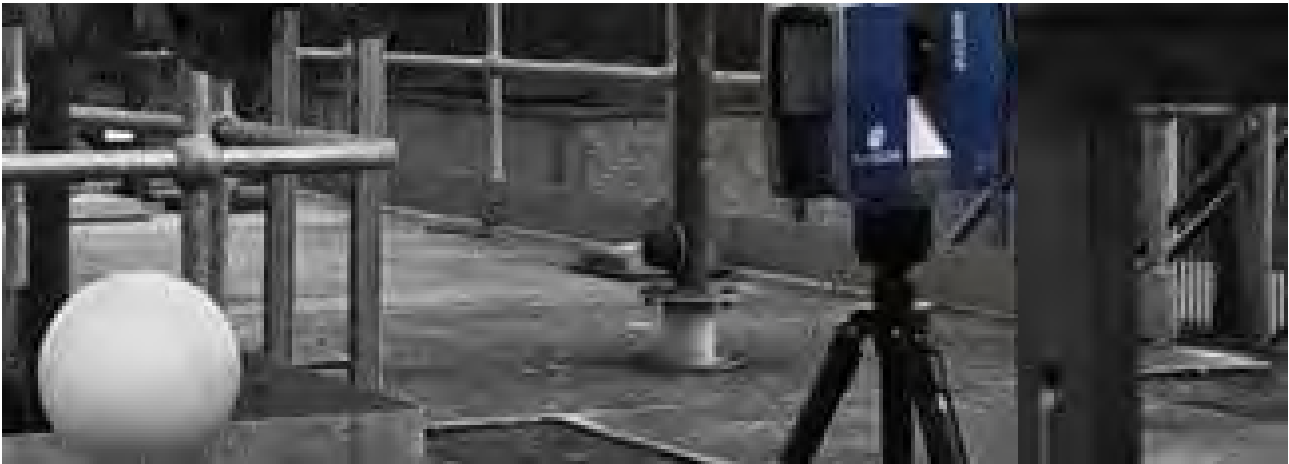
Fig. 31 - Escáner y esfera durante un levantamiento (Fuente: https://blog.studioglobalgeo.it/tutto-quello-che-devi-sapere-sulla-registrazione-dati-laser-scanner ).
