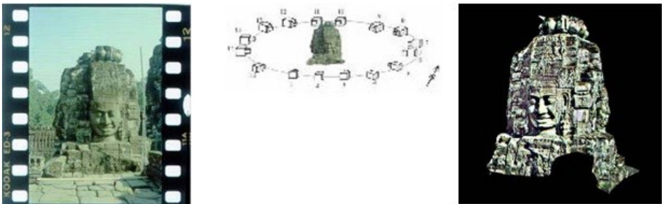
Fig. 53 - Generación del modelo tridimensional del Buda de Bayón (Camboya) mediante proceso fotogramétrico (Fuente: Gruen, 2008a).
