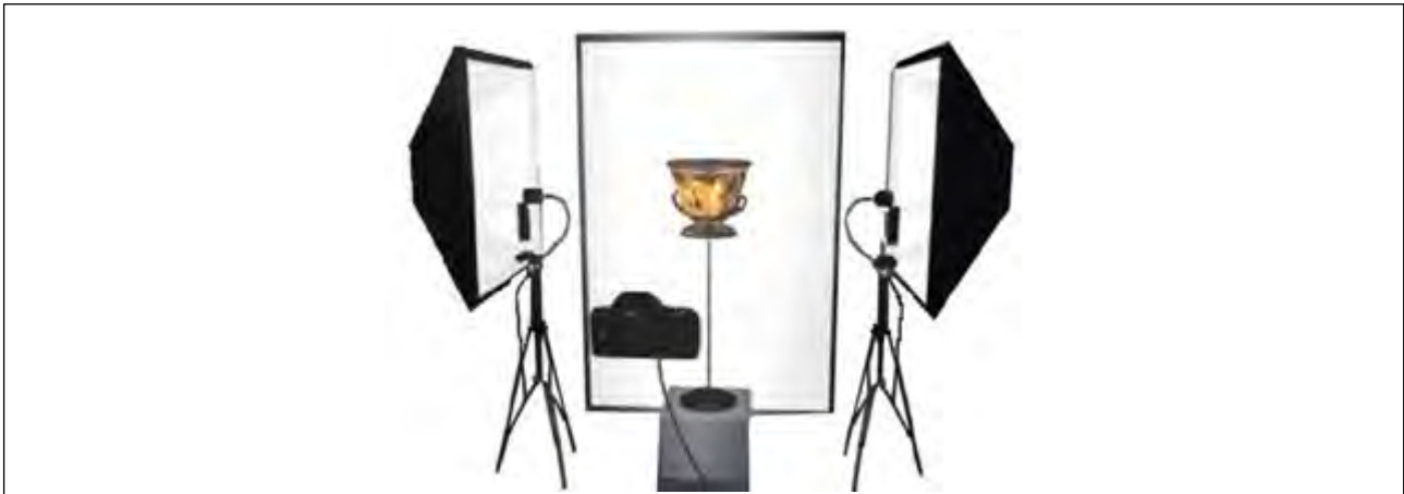
Fig. 54 - Modelización tridimensional mediante la técnica de la silhouette (Fuente: Gilardoni, 2007).
