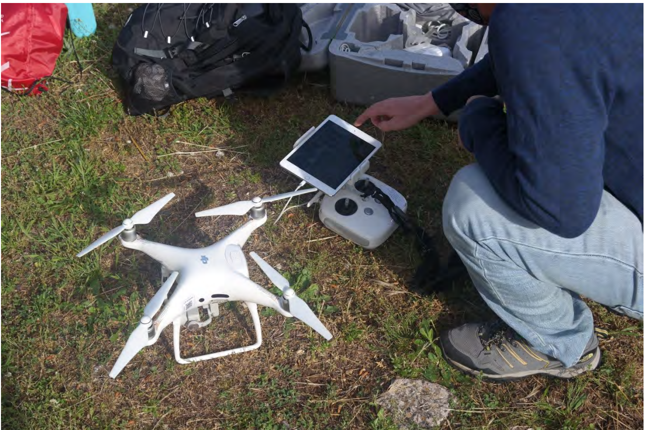
Fig. 60b - El dron DJI Phantom 4 ©: configuración de los controles (Fuente: Autor).
