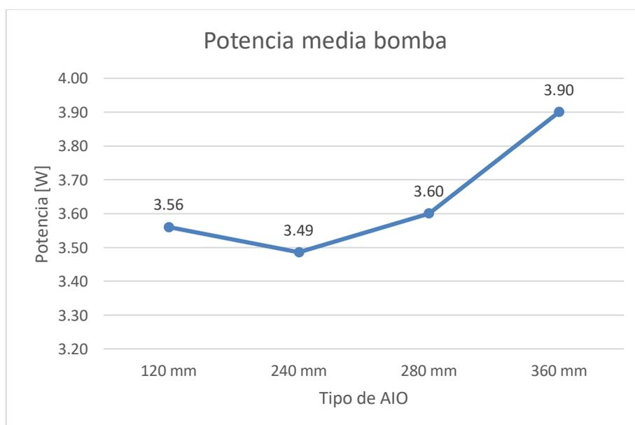
Figura 25: Potencia bomba/Tipo AIO
