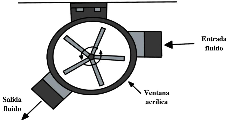
Figura 43: Diseño conceptual indicador de flujo
