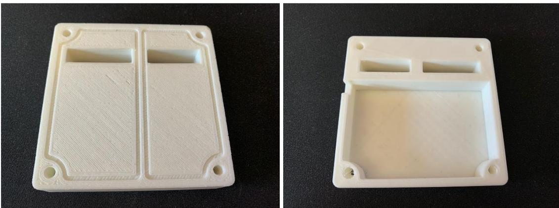
Figura 85: Prototipo cámara bomba
