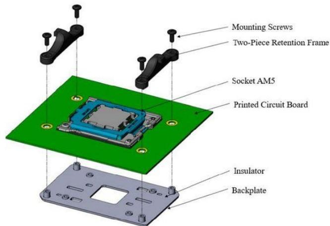
Figura 20: Esquema sistema montaje estándar AM5 [29]
