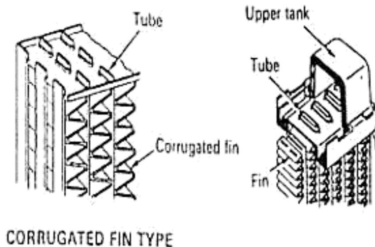
Figura 6: Aletas metálicas radiador [8]
