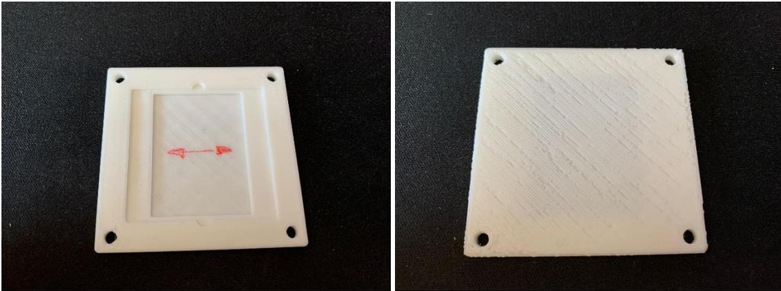
Figura 89: Prototipo intercambiador de calor
