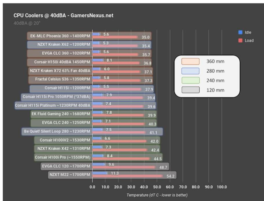
Figura 36: Benchmark temperaturas AIO normalizado a 40dB [35]
