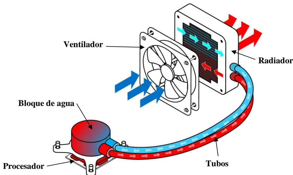
Figura 2: Esquema sistema AIO [4]
