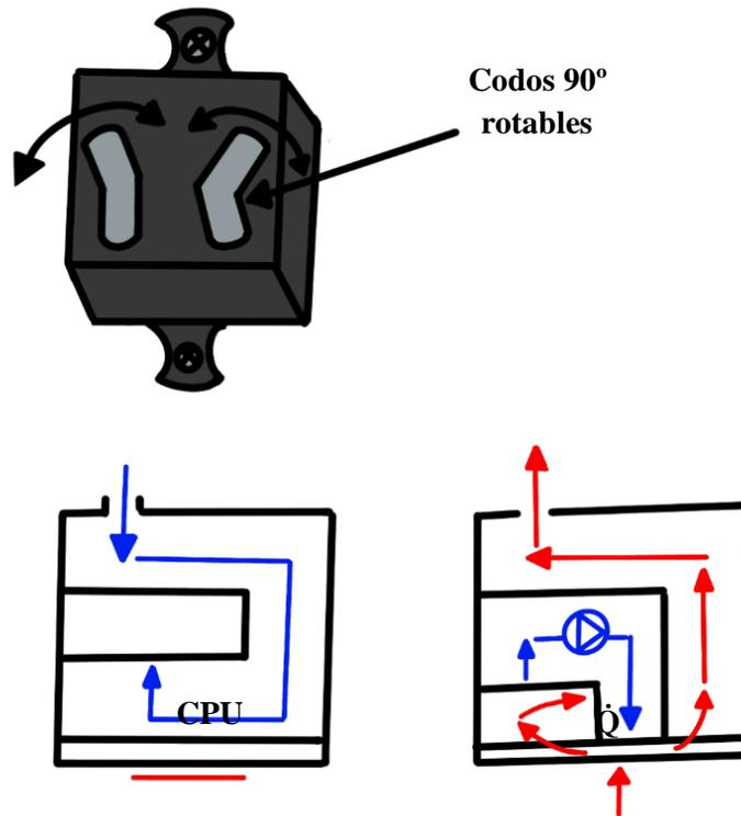
Figura 45: Diseño conceptual bloque de agua
