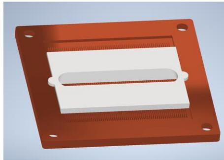
Figura 60: Modelo intercambiador de calor y difusor
