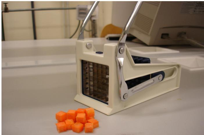
**Figura 3.1.1. Dispositivo para el corte de la zanahoria en forma de cubos (8.5 mm de lado).**
