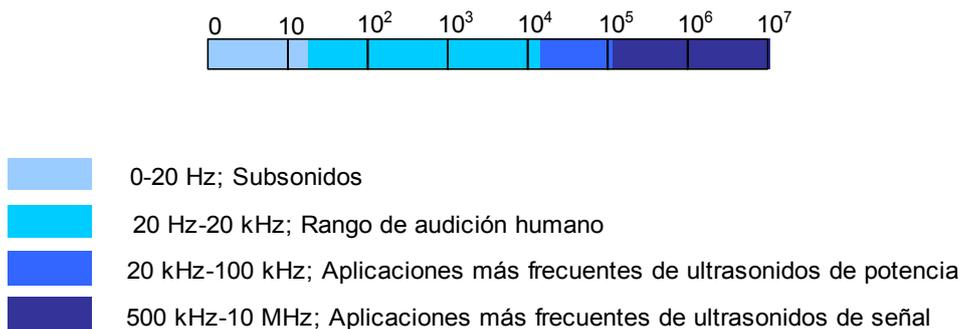
**Figura 1.2.2. Clasificación del sonido en función de la frecuencia.**
