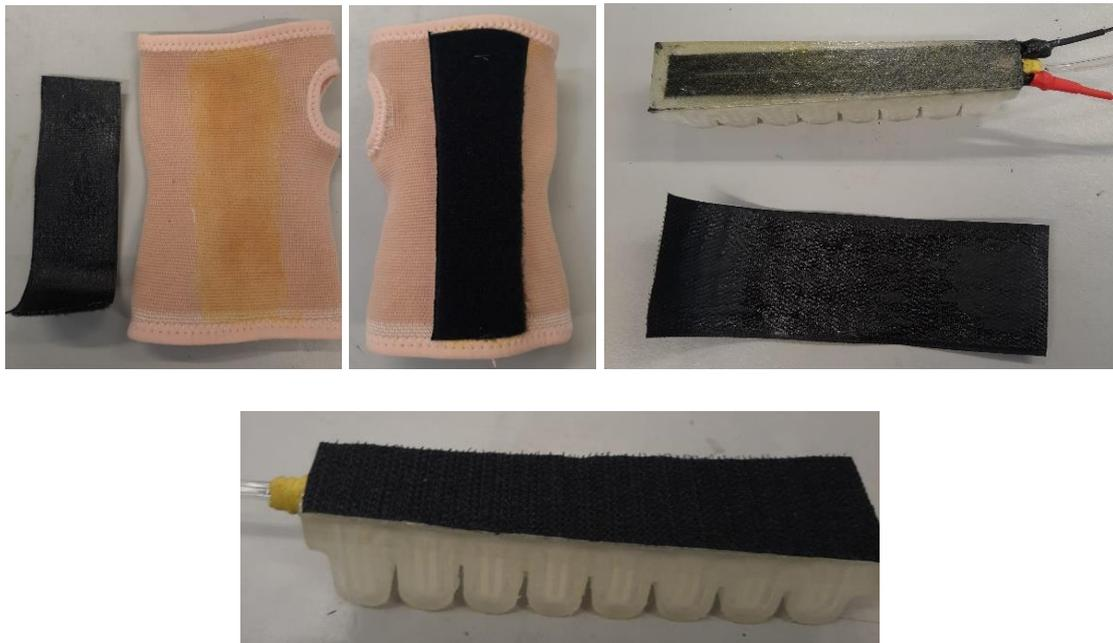
**Figura III. 22.** Unión del velcro con la muñequera y el actuador mediante cola de contacto.
