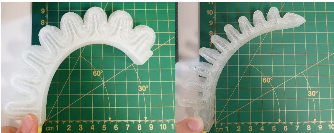
**Figura III. 17.** Comprobación de ángulo de flexión entre los dos tipos de actuadores funcionales.
