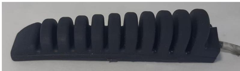
**Figura III. 12.** Primer modelo fabricado con resina elástica 50 A en SLA.
