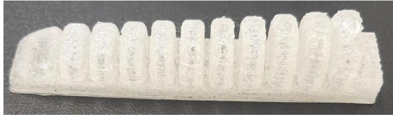
**Figura III. 13.** Primer modelo fabricado con filamento Filaflex 70A en FDM.
