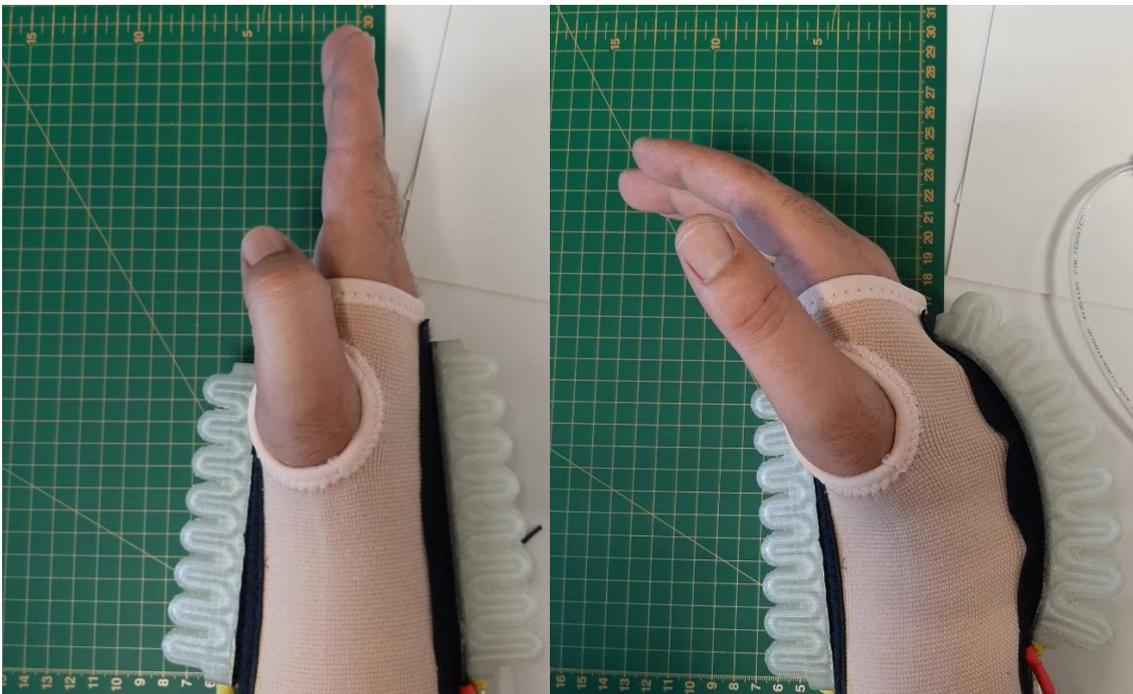
*Figura III. 29. Flexión del del prototipo demostrador del actuador superior.*
