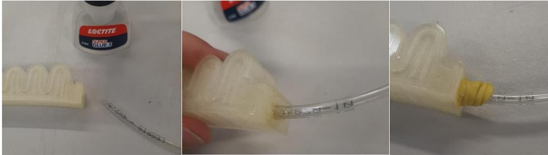
**Figura III. 20.** Aplicación de cianoacrilato y masilla de sellado para la conexión del actuador y el tubo neumático.
