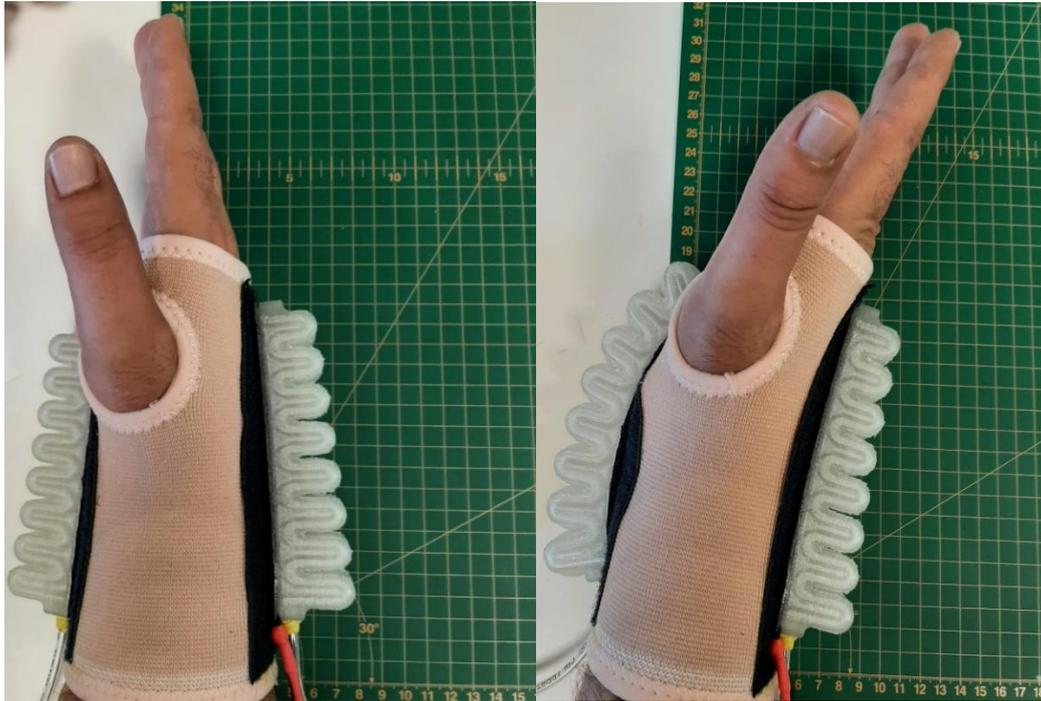
*Figura III. 30. Flexión del del prototipo demostrador del actuador inferior.*
