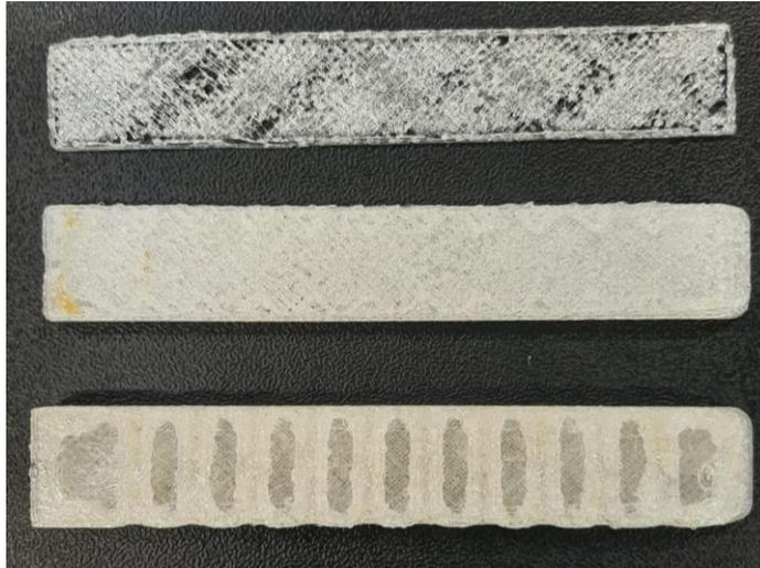
**Figura III. 11.** Pruebas iniciales de la fabricación del actuador en FDM con material FilaFlex 70A.
