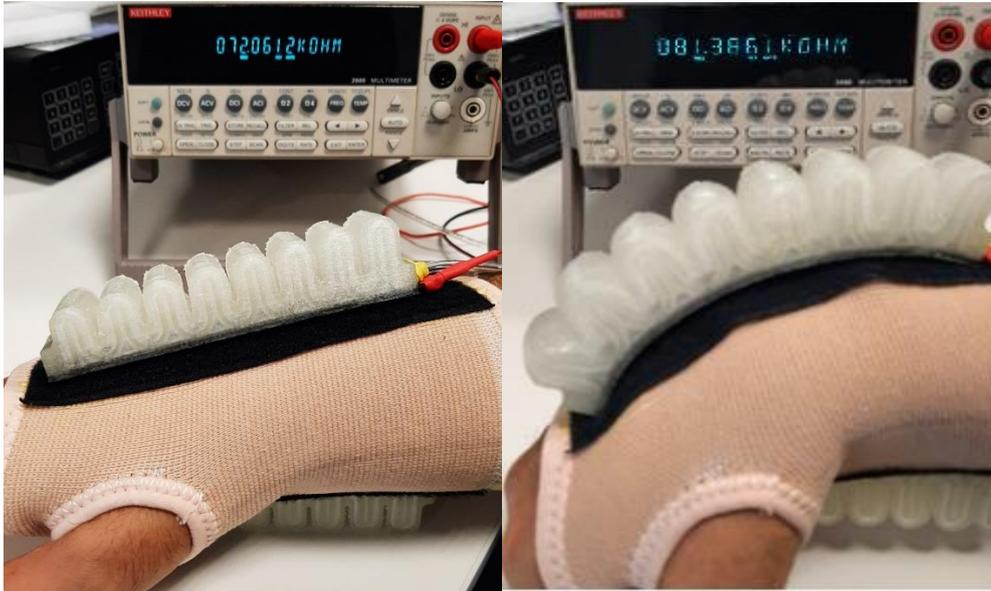
*Figura III. 31. Demostrador en funcionamiento conectado al multímetro observando la variación de resistencia.*
