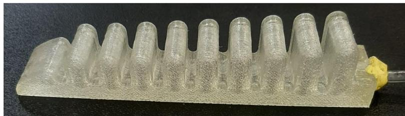
*Figura III. 15. Segundo modelo fabricado con filamento Filaflex 70A en FDM.*
