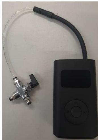
*Figura III. 24. Compresor y válvula de cierre para aplicar presión al actuador.*
