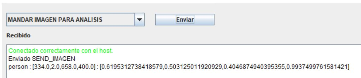
Tras ser seleccionada, la imagen es serializada en nuestro PC y enviada al monitor del equipo remoto, tras esto, el monitor almacenará la imagen de manera temporal, indicando a continuación a YOLOv5 (detect.py) el comando recibido y la ubicación de la imagen. Posteriormente, la imagen es analizada por YOLOv5, extrayendo sus características y devolviéndolas a nuestro PC de forma idéntica a como ocurría la funcionalidad “Obtener información actual.”.
