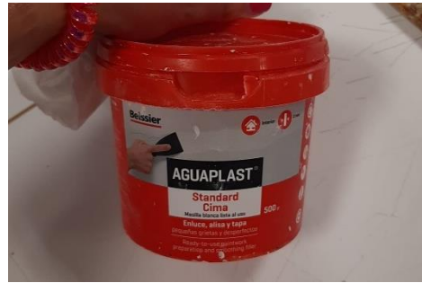
Ilustración 63: Masilla utilizada en las uniones.
