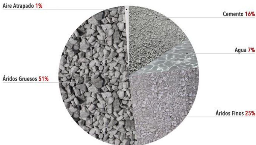
Ilustración 22: Composición del hormigón [32].
