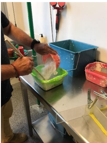
Ilustración 57: Elaboración y vertido de la escayola.
