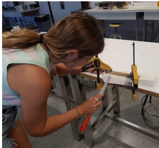
Ilustración 60: Mejorando el acabado superficial con una lima.
