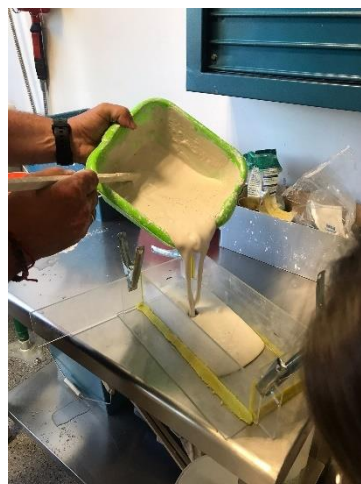
Ilustración 57: Elaboración y vertido de la escayola.
