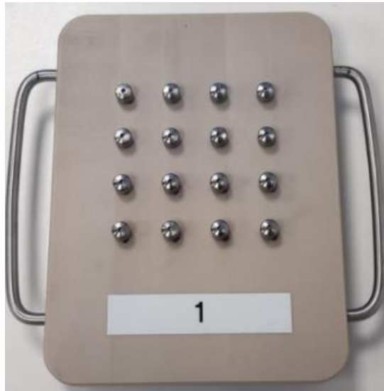
Ilustración 32. Posiciones dentro del útil de grabado dónde se colocan las piezas a grabar. [Fuente propia].
