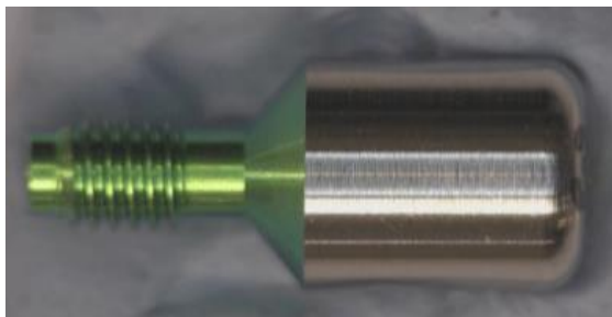
Ilustración 20. Perfil del pilar de cicatrización parcialmente anodizado [Fuente propia].
