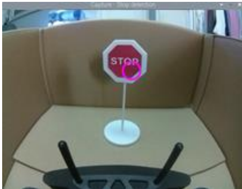
Figura 53. Detección de señales de “stop” con red neuronal desarrollada a partir de una base de datos de imágenes positivas tomadas por el usuario y con los parámetros “minneighbours” o “scale” ajustados.
