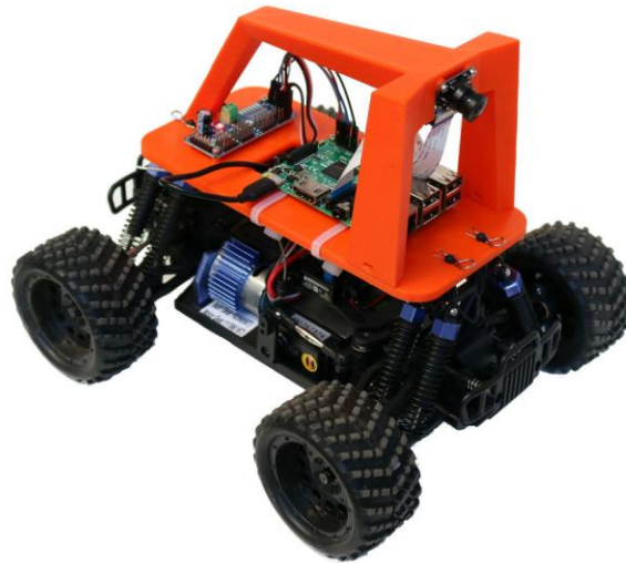
Figura 1. Vehículo autónomo construido en el proyecto “Donkeycar”.
