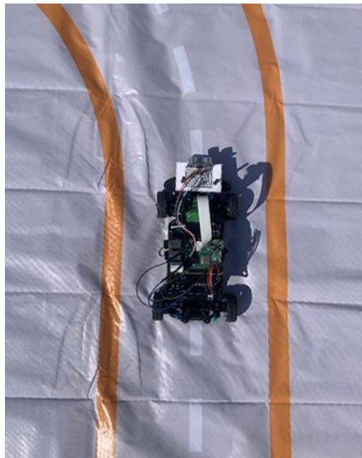
Figura 22. Posición determinada donde se ha situado el vehículo considerando que debería empezar a detectar la curva.
