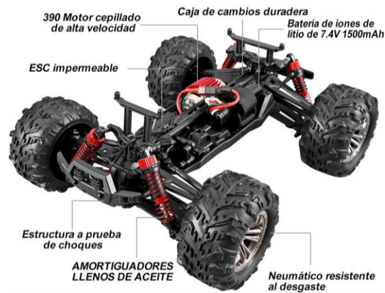
Figura 11. Coche radiocontrol YONCHER YC200.
