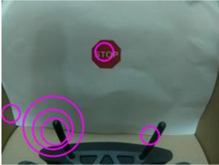
Figura 54. Detección de señales de “stop” con red neuronal desarrollada a partir de una base de datos de imágenes positivas creadas por el sistema.
