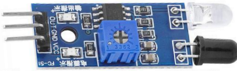
Figura 8. Sensor de distancia por luz IR.
