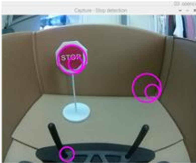
Figura 52. Detección de señales de “stop” con red neuronal desarrollada a partir de una base de datos de imágenes positivas tomadas por el usuario.
