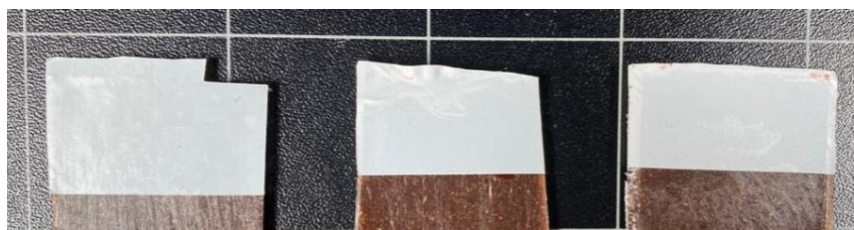
Figura 70. Estado del adhesivo tras el ensayo de cizalla en los substratos de BioHDPE/PE-g-MA/10%PC. De izquierda a derecha: sin tratamiento, con tratamiento superficial a 6 mm y con tratamiento superficial a 10 mm.
