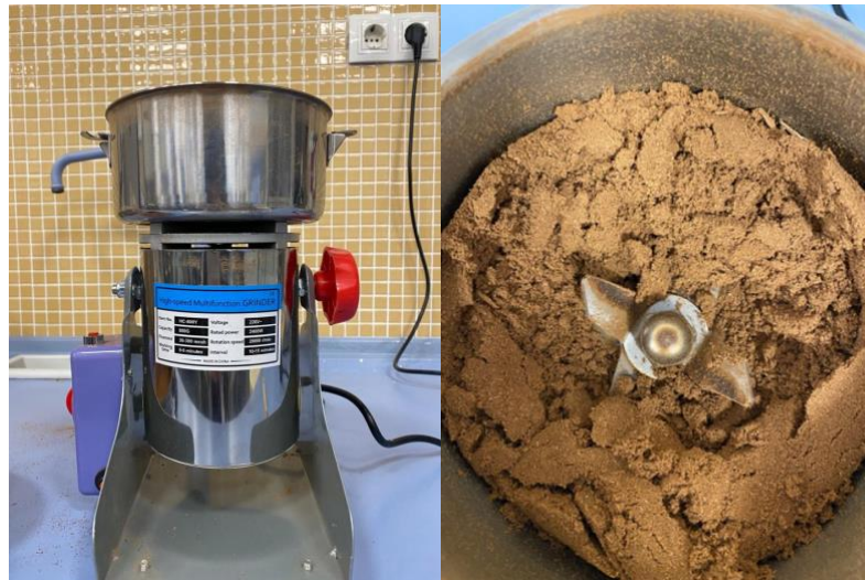
Figura 16. A la izquierda el molino centrífugo convencional utilizado y a la derecha la fibra de piña molida en la etapa final.
