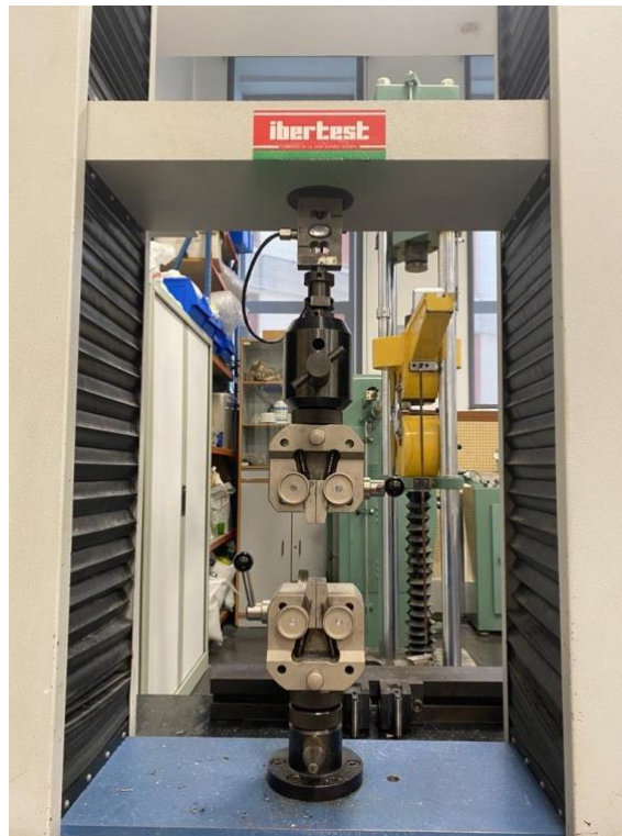
Figura 25. Máquina de tracción ELIB 50 (Ibertest) donde se pueden ver las mordazas utilizadas y la carga de 5kN empleada en la parte superior.
