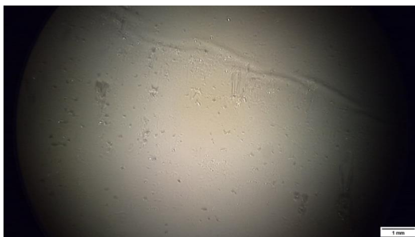
Figura 63. Imagen aumentada del estado del substrato de BioHDPE tras el ensayo de cizalla sin tratamiento superficial.
