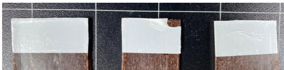
Figura 74. Estado del adhesivo tras el ensayo de cizalla en los substratos de BioHDPE/PE-g-MA/5%PC. De izquierda a derecha: sin tratamiento, con tratamiento superficial a 6 mm y con tratamiento superficial a 20 mm.
