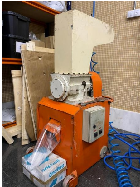
Figura 18. Unidad de corte por aire (trituradora).
