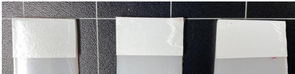
Figura 62. Estado del adhesivo tras el ensayo de cizalla en los substratos de BioHDPE puro. De izquierda a derecha: sin tratamiento, con tratamiento superficial a 6 mm y con tratamiento superficial a 10 mm.
