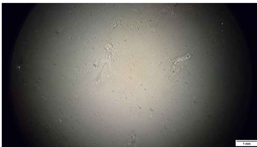
Figura 76. Imagen aumentada del estado del substrato de BioHDPE/PE-g-MA/20%PC tras el ensayo de cizalla con tratamiento superficial a 6 mm.
