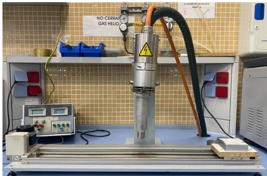
Figura 21. Equipo de tratamiento de plasma atmosférico donde se puede ver el actuador lineal y el bastidor.
