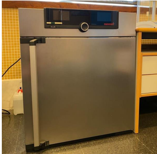
Figura 26. Cámara de humedad HCP Memmert, Alemania.
