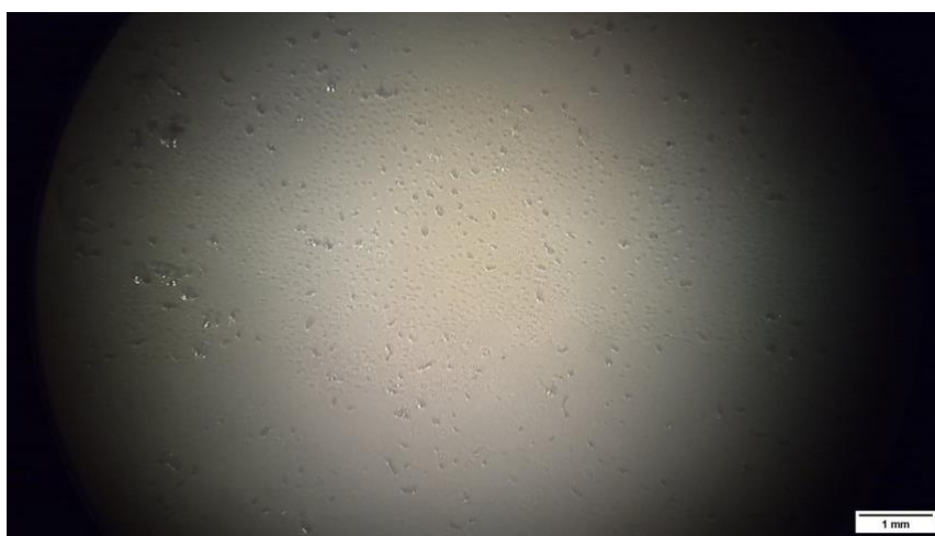
Figura 67. Imagen aumentada del estado del substrato de BioHDPE/PE-g-MA/5%PC tras el ensayo de cizalla sin tratamiento superficial.
