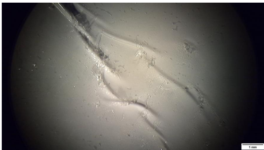
Figura 77. Imagen aumentada del estado del sustrato de BioHDPE/PE-g-MA/5%PC tras el ensayo de cizalla con tratamiento superficial a 10 mm.
