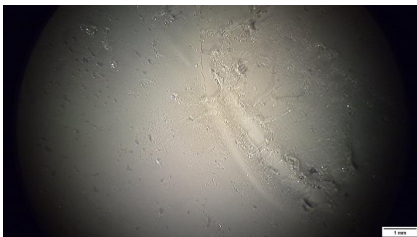
Figura 72. Imagen aumentada del estado del substrato de BioHDPE/PE-g-MA/10%PC tras el ensayo de cizalla con tratamiento superficial a 6 mm.
