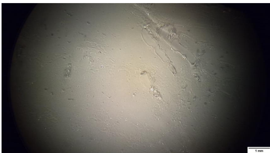
Figura 68. Imagen aumentada del estado del substrato de BioHDPE/PE-g-MA/5%PC tras el ensayo de cizalla con tratamiento superficial a 6 mm.
