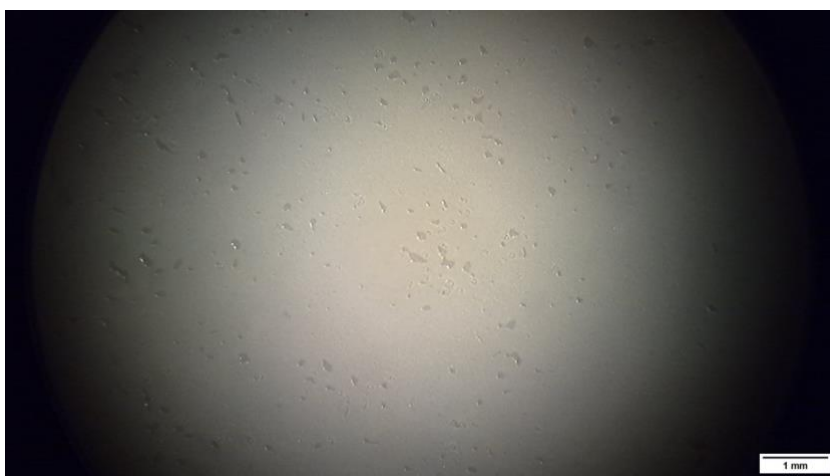
Figura 75. Imagen aumentada del estado del substrato de BioHDPE/PE-g-MA/20%PC tras el ensayo de cizalla sin tratamiento superficial.
