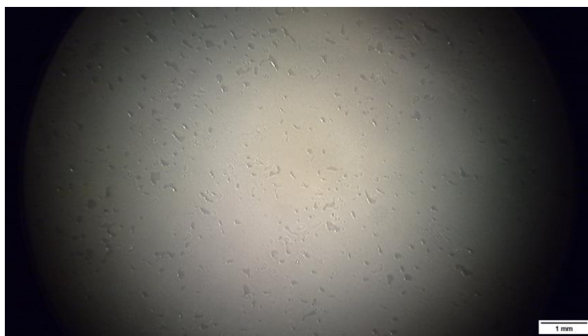
Figura 71. Imagen aumentada del estado del substrato de BioHDPE/PE-g-MA/10%PC tras el ensayo de cizalla sin tratamiento superficial.
