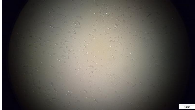
Figura 65. Imagen aumentada del estado del sustrato de BioHDPE tras el ensayo de cizalla con un tratamiento superficial a 10 mm.
