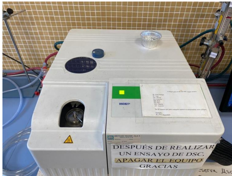
Figura 27. Calorímetro diferencial de barrido. Mettler-Toledo 821.
