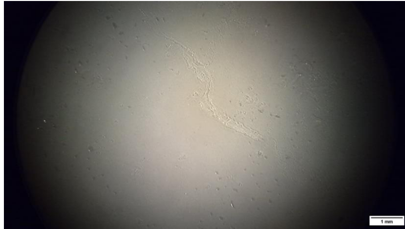
Figura 73. Imagen aumentada del estado del sustrato de BioHDPE/PE-g-MA/10%PC tras el ensayo de cizalla con tratamiento superficial a 10 mm.
