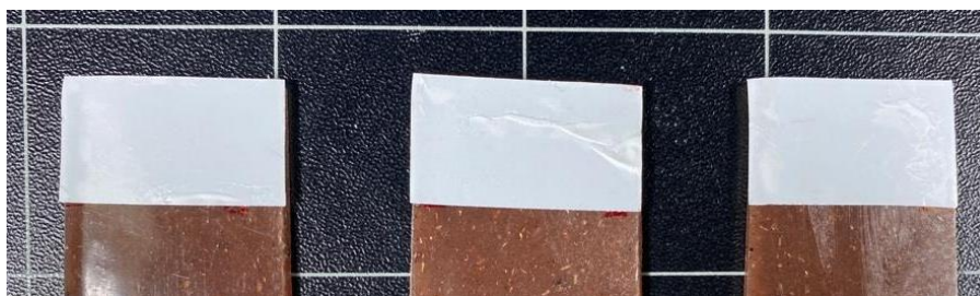
Figura 66. Estado del adhesivo tras el ensayo de cizalla en los substratos de BioHDPE/PE-g-MA/5%PC. De izquierda a derecha: sin tratamiento, con tratamiento superficial a 6 mm y con tratamiento superficial a 10 mm.
