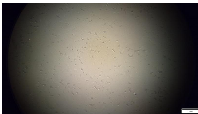
Figura 63. Imagen aumentada del estado del substrato de BioHDPE tras el ensayo de cizalla sin tratamiento superficial.
