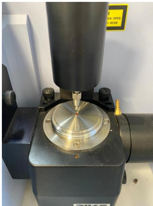
Figura 28. Detalle del ATR del equipo de infrarrojos por transformada de Fourier Bruker, Vector 22.
