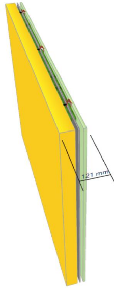
Ilustración 6: Montante Acero Galvanizado con soporte antivibratorio INSUL
