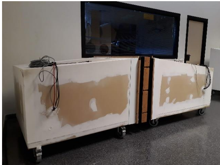
Figura 7: Cámara de transmisión acústica de dimensiones reducidas
