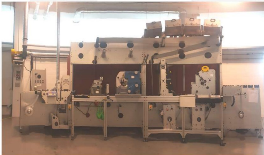
Figura 25 Plantas piloto de flexografía roll-to-roll . Modelo Lambda de Edale en NAITEC.
