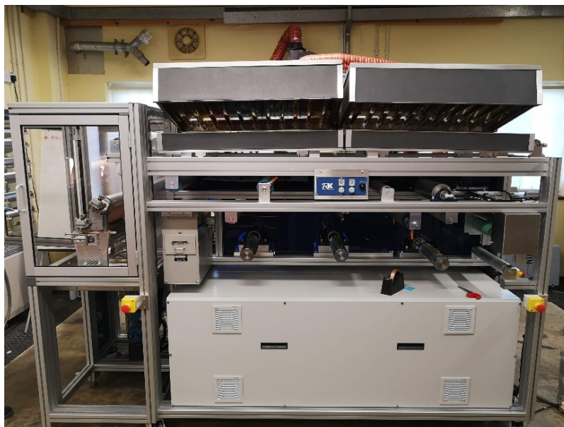
Figura 26 Plantas piloto de flexografía roll-to-roll . VCML Lab de RK Print en AITEX.
