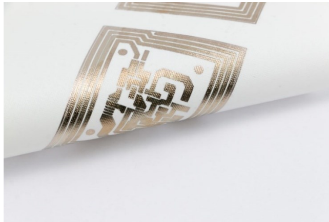
Figura 31 Impresión electrónica mediante serigrafía
