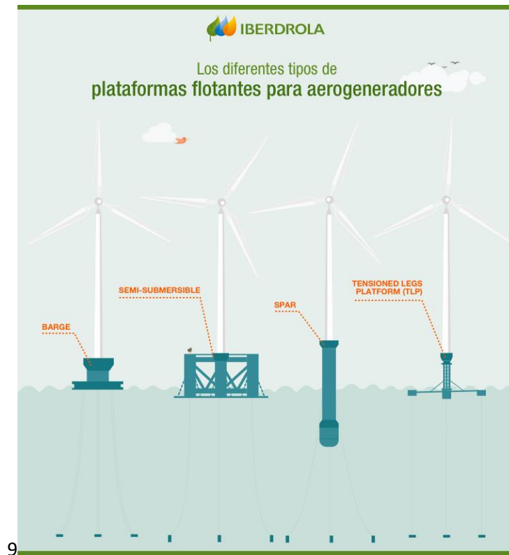
Figura 32. Tipos de plataforma flotante para eólica marina. Fuente (Iberdrola, 2022).
