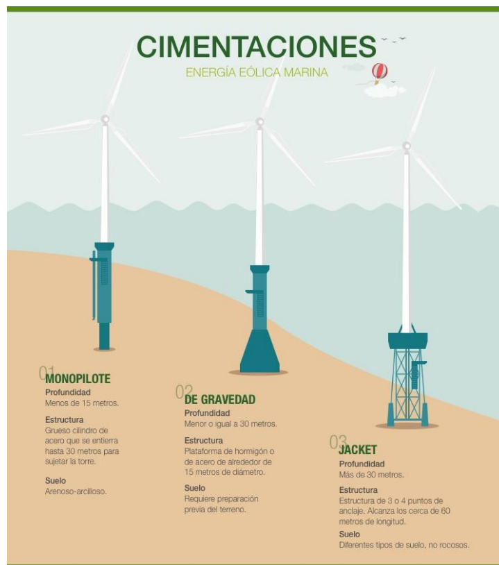
Figura 30. Tipos de cimentaciones fijas en la eólica marina. Fuente (iberdrola, 2022) .
