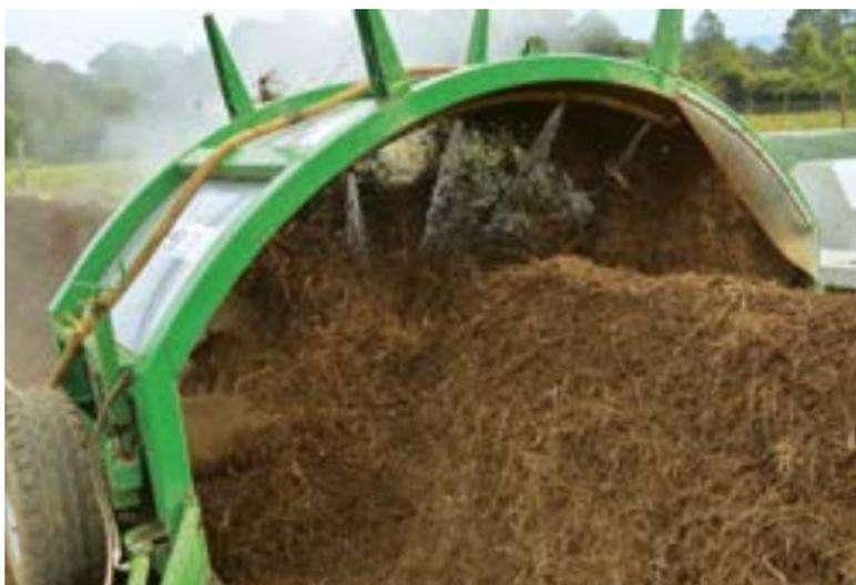
Figura 25: Maquina volteadora con sistema de riego. [38]
