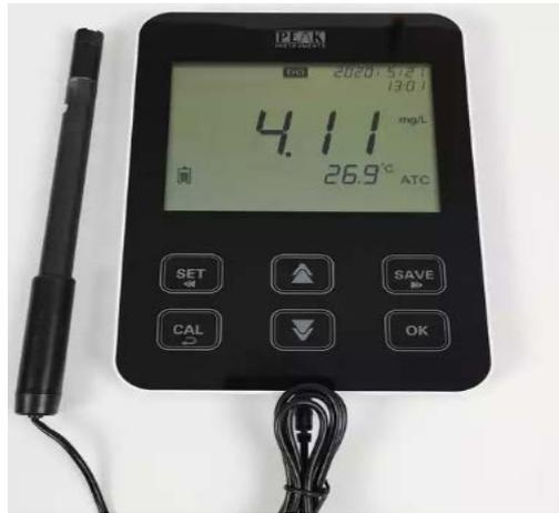
Figura 30: Medidor de oxígeno. [42]
