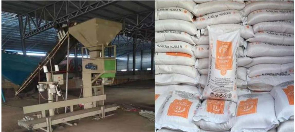
Figura 35: Máquina ensacadora. [43]
