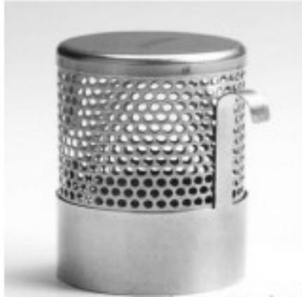
**Ilustración 6. Bolsa metálica para cocción (Maltacervceros, s.f.)**
