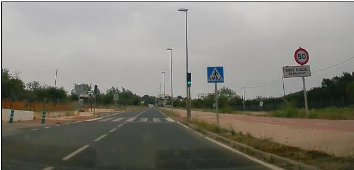
Figura 119. Señalización S-500 y R-301 50 km/h a la entrada a Sant Miquel de Balansat en sentido creciente de la carretera EI-400.
