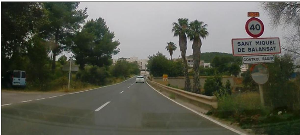
*Figura 100. Señalización S-500 y R-301 40 km/h a la entrada a Sant Miquel de Balansat en sentido decreciente.*
