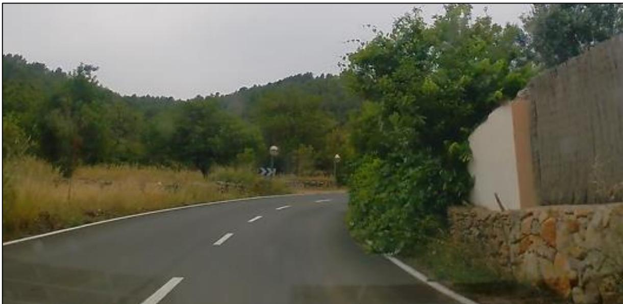
*Figura 133. Curva con visibilidad reducida y línea discontinua como separador central en la carretera EI-541 PK 2+000.*
