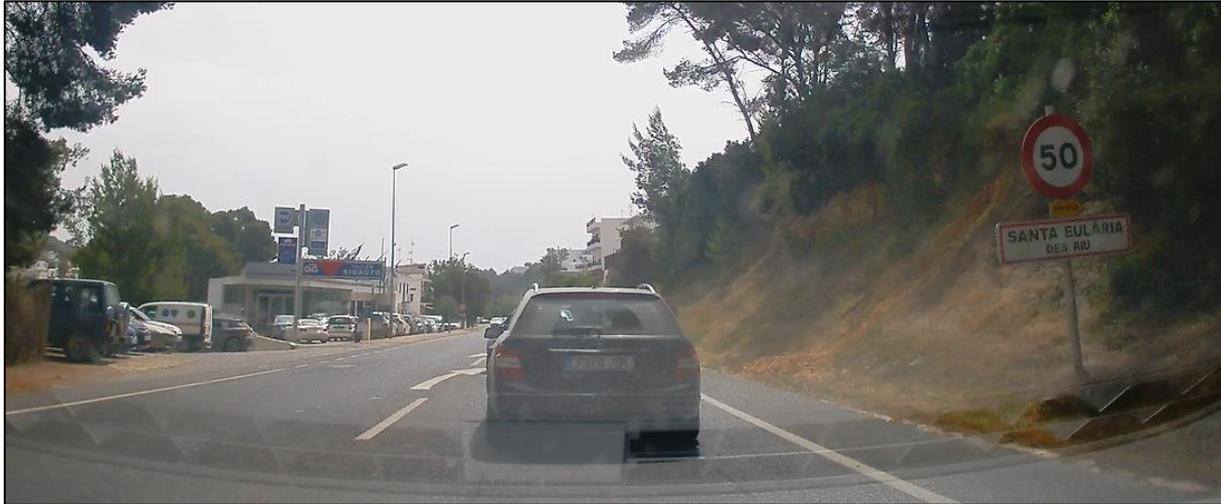
Figura 52. Inicio del límite de la población de Santa Eulalia del Río en sentido creciente (señal vertical R-301 50 km/h y señal vertical S-500).
