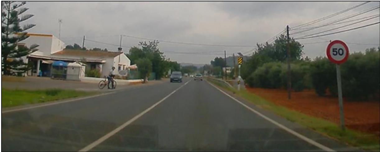
Figura 54. Ubicación de la señal vertical R-301 50 km/h y el radar de velocidad previo a la intersección de la carretera EI-200 PK 8+300 en sentido creciente.
