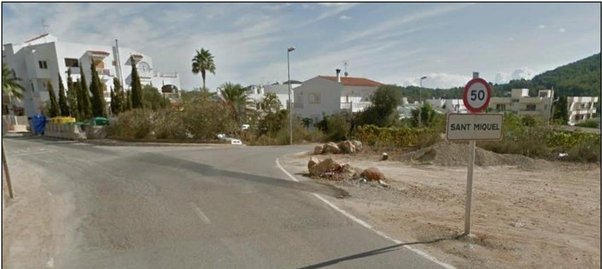
*Figura 137. Señalización S-500 y R-301 50 km/h en la entrada a Sant Miquel en la carretera EI-541.*
