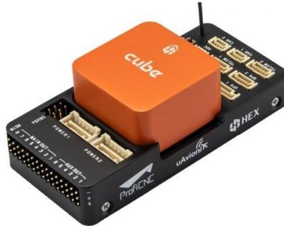
Figura 3.2. Controladora Cube Orange de Cube Pilot. [19]
