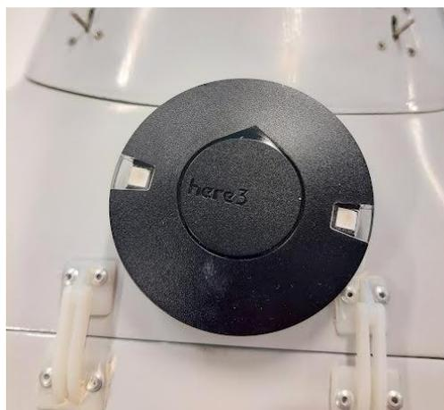
Figura 3.4. Dispositivo Here3 montado sobre la parte superior de la aeronave.
