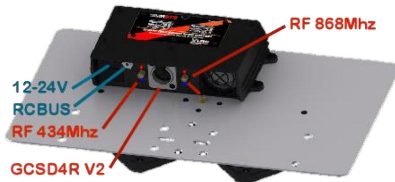
Figura 4.4. Receptor redundante y antena bidireccional. [11]
