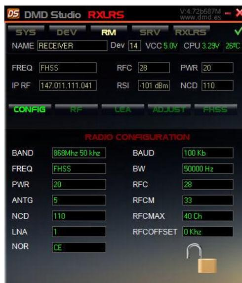
Figura 5.19. Configuración de radio principal en DMD Studio.[11]
