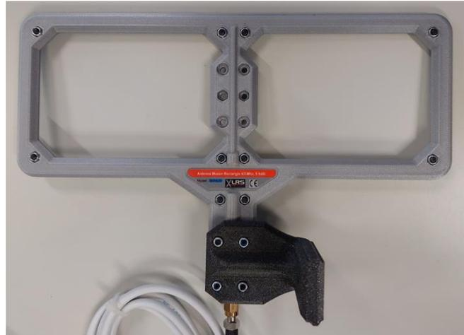
Figura 4.5. Antena secundaria 433 MHz.
