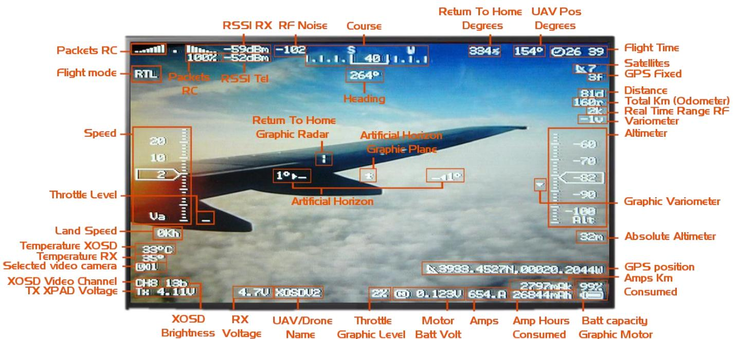
Figura 5.20. Objetos e instrumental de vuelo superpuestos al video de la cámara FPV.[11]
