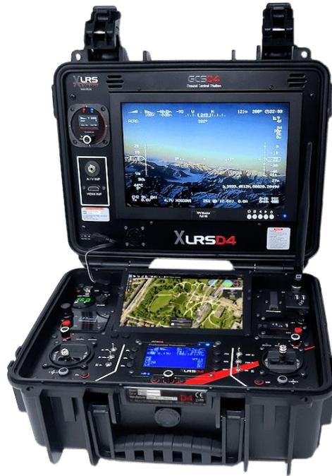
Figura 4.3. Estación de control en tierra GCSD4 V2. [11]
