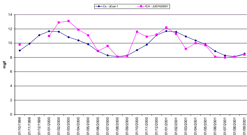
Calibración Júcar-1. Oxígeno Disuelto
