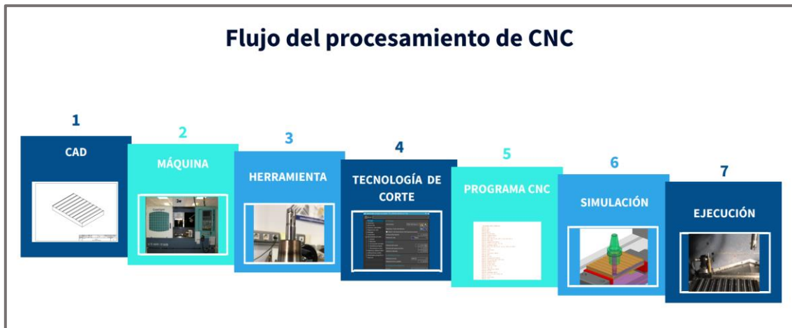
Figura 39. Ruta para el procesamiento de un programa CNC (fuente: elaboración propia).
