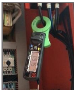
Figura 47. Toma de datos de corriente en una fase de la máquina (fuente: elaboración propia).
