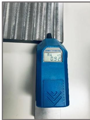
Figura 41. Toma de datos con el rugosímetro (fuente: elaboración propia).
