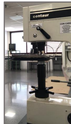
Figura 42. Toma de datos con el durómetro (fuente: elaboración propia).
