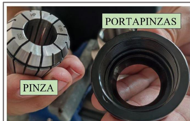
Figura 22. Pinzas ER32 diámetro 16 mm junto con tapa de portapinzas (fuente: Morris, 2022)
