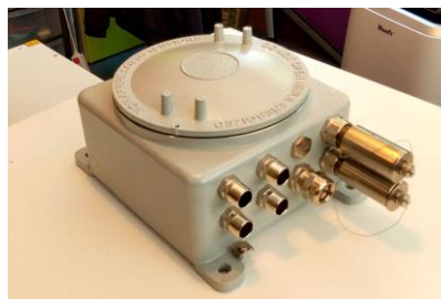
Figura 9: Carcasa para Raspberry pi para ambientes industriales explosivos. Fuente: https://www.jeffgeerling.com/blog/2022/industrial-raspberry-pi-computers-one-explosion-proof
