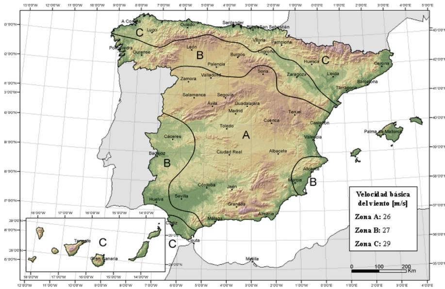
Imagen 6. Figura D.1 Valor básico de la velocidad del viento, vb
