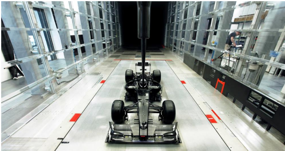
Figura 1.2: Toyota TF110 durante un ensayo en un túnel de viento. (Fuente: F1framework blog ).
