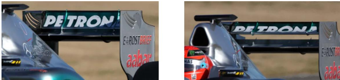
Figura 1.5: Drag Reduction System (DRS) incorporado en el alerón de un Formula 1. Vistas del DRS cerrado (izquierda) y abierto (derecha). (Fuente: printerest.com )
