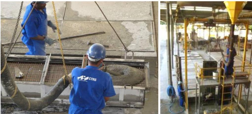
Fig. 77 Vertido en los dos tipos de moldes, horizontal y vertical
