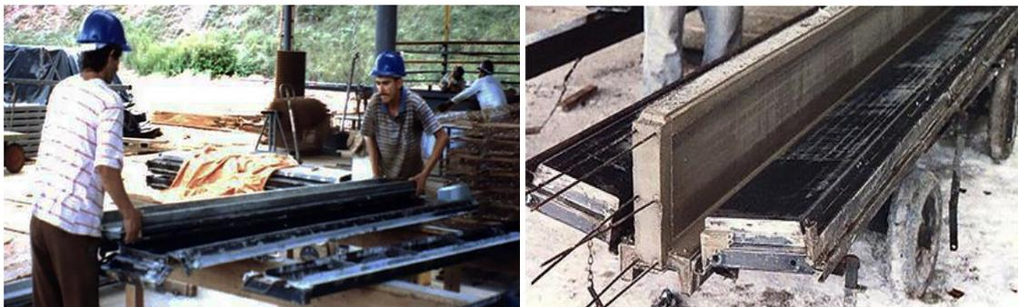
Fig. 79 Desmolde de viga por operarios
