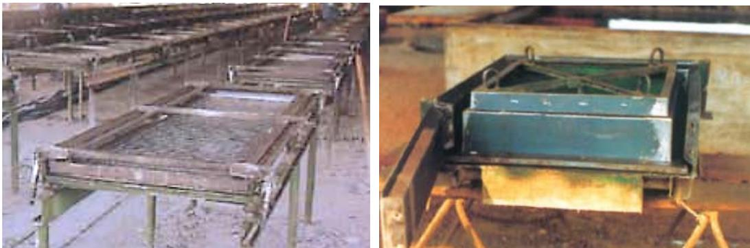
Fig. 73 Moldes de acero simple y doble respectivamente
