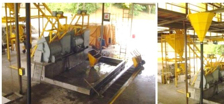
Fig. 76 Mezcladora motorizada de argamasa armada
