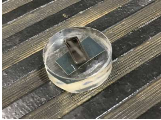
Figura 24. Preparación de las muestras embutidas con resina transparente TransOpic Buehler con los bordes pintados con laca de uñas para el ensayo de liberación de iones.
