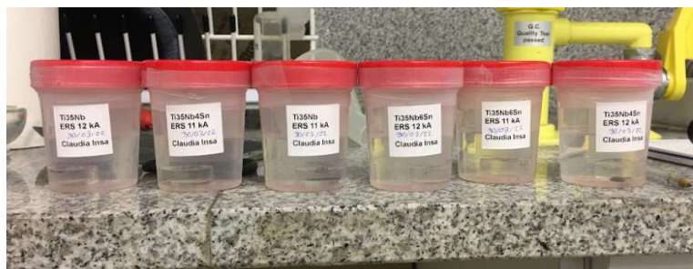
Figura 25. Recipientes que contienen nuestras muestras y la solución de Ringer-Hartman listos para el ensayo de liberación de iones.
