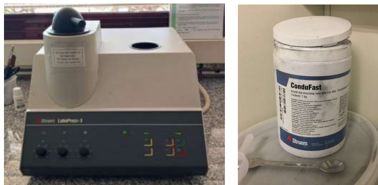
Figura 19. Embutidora LaboPress-3 Struers (imagen de la izquierda). Resina negra ConduFast Struers (imagen de la derecha).
