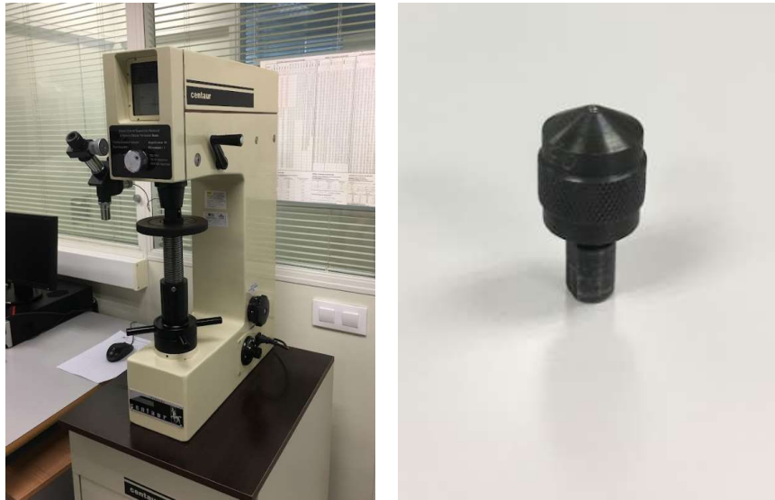
Figura 13. Durómetro HD9-5 Centaur (imagen de la izquierda). Penetrador Rockwell Bola (imagen de la derecha).
