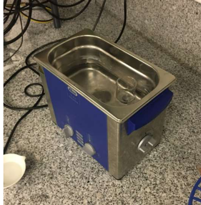
Figura 21. Baño de ultrasonidos de las probetas en etanol.
