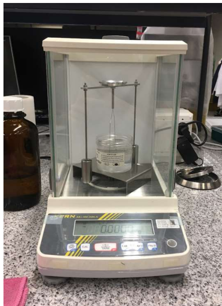
Figura 12. Montaje para el ensayo de Arquímedes en la Balanza de precisión Kern 770.
