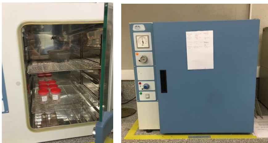
Figura 26. Horno Selecta 2000207 donde dejaremos nuestras muestras en el interior para el ensayo de liberación de iones.
