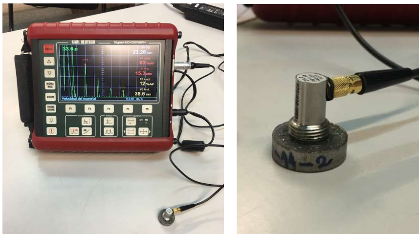
Figura 16. Equipo Karl Deutsh Echograph para realizar el ensayo del módulo elástico (imagen de la izquierda). Palpador DS6 PB4-14 para obtener las ondas longitudinales (imagen de la derecha).
