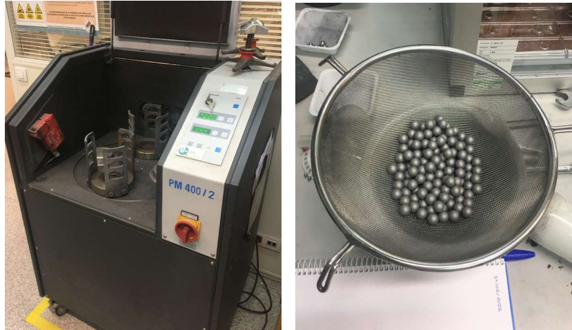
Figura 9. Molino planetario PM400 Retch (imagen de la izquierda). Bolas de acero cromado (imagen de la derecha).
