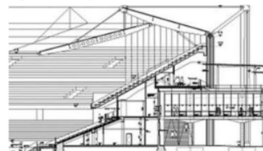
Figura 129. Sección de la tribuna oeste
