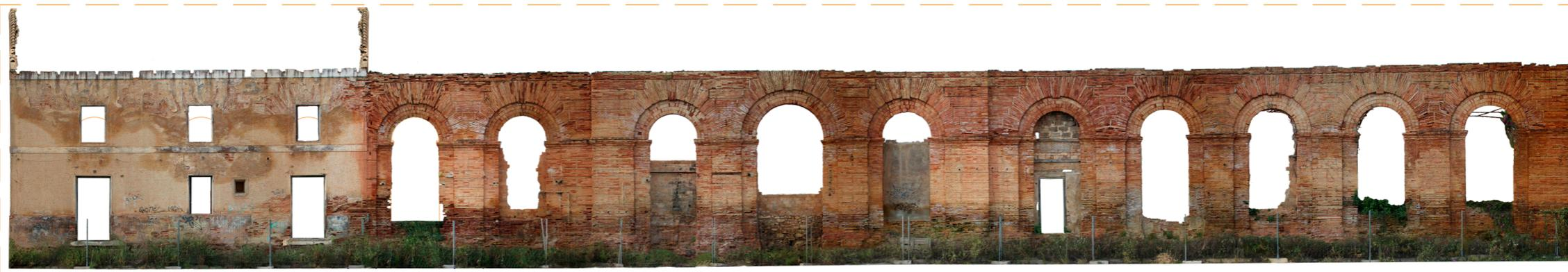
Img. 4.9 Hipótesis del alzado principal de la estación sin realizar la rehabilitación de la Fase 3. E: 1/200. Mediante la aplicación de PhotoScan.
