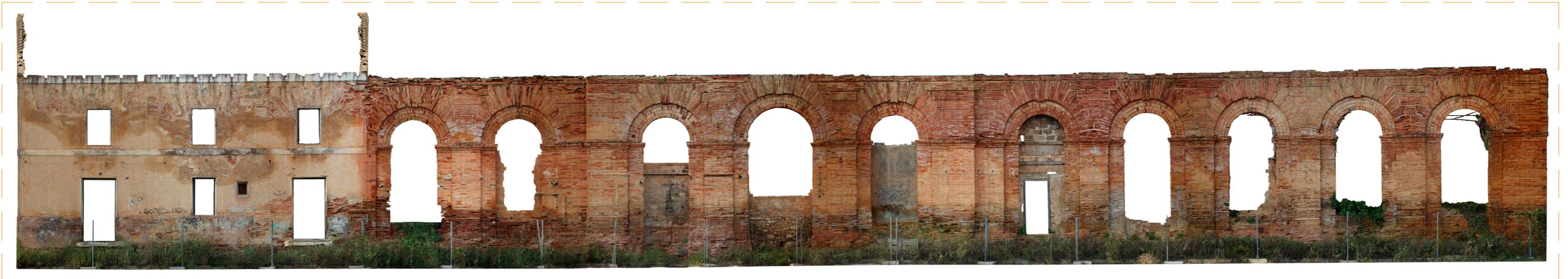
Img. 13.6 Alzado Norte de la antigua estación de ferrocarril de Xàtiva. E: 1/150. Mediante la aplicación de PhotoScan.
