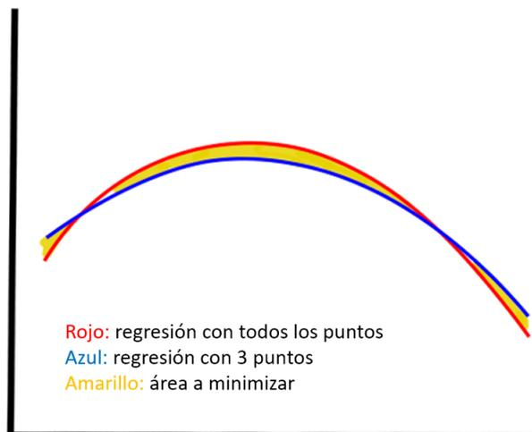
**Figura 18.** Diagrama del método realizado para el cálculo del ángulo de inclinación intermedio.
