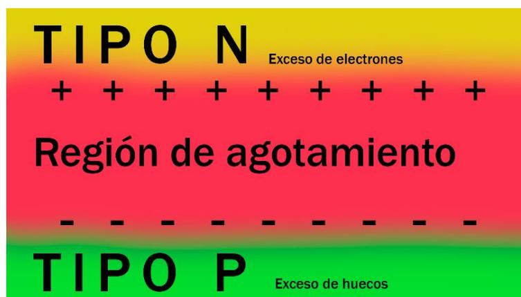
**Figura 2.** Esquema unión PN con región de agotamiento.
