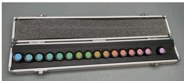
Figura 23: Casquillos removibles para la prueba Farnsworth-Munsell de dicotomía D-15. Fuente: Autora
