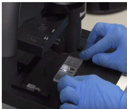
Fig.12 Imagen del enfoque de la cuadrícula de la cámara Neubauer al microscopio
