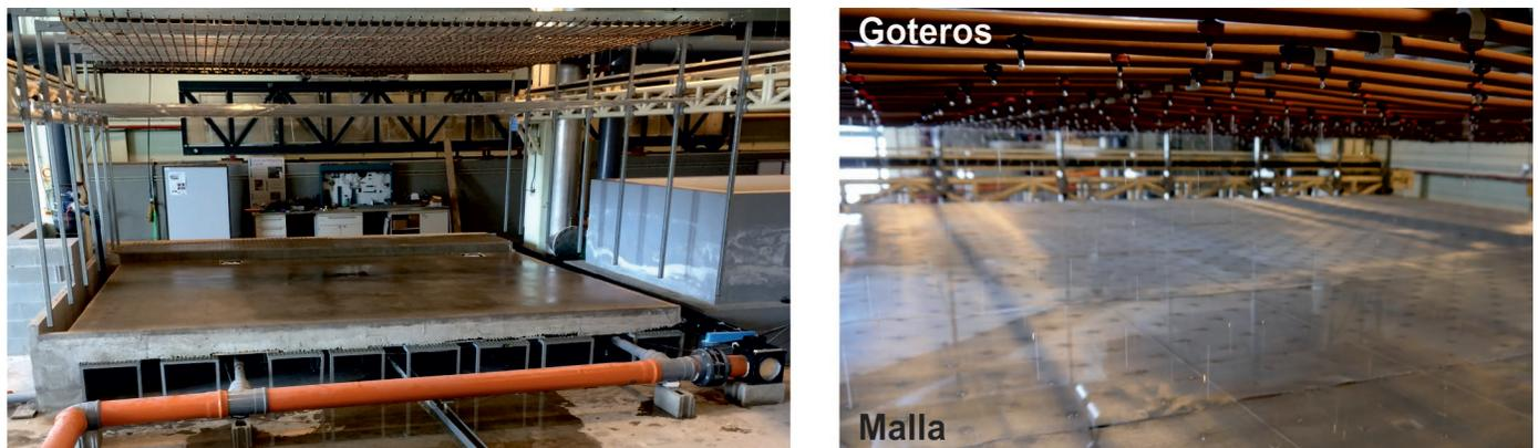
Figura 1 | Foto general de la instalación (izquierda) y detalle del sistema de generación de lluvia (derecha).
