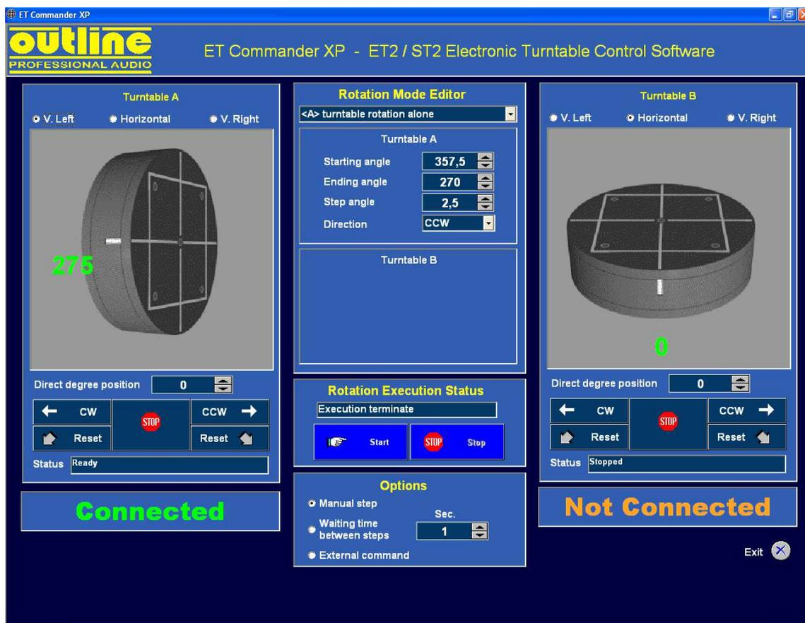
Fig.50. Aspecto del software utilizado para controlar el motor de giro en las medidas de directividad.
