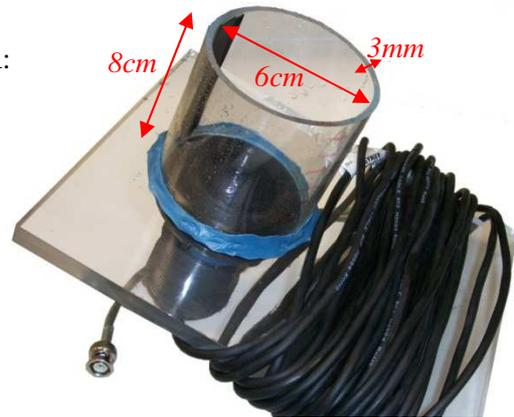
Como se muestra en la figura, se ha añadido un tubo cilíndrico de metacrilato de 8cm de altura cuyo diámetro interior es de 6cm y exterior de 6.6cm, es decir, con un espesor de 0.3cm. Con ello, se ha podido introducir material en su interior, con el que se han realizado todas las medidas.
