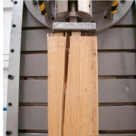
Figura 13. Ejemplo de fallo de las probetas a compresión.
