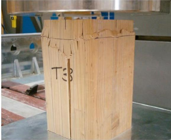
Figura 12. Ejemplo de fallo de las probetas a compresión.
