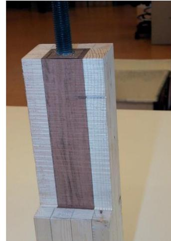
Figura 17. Tacos de madera en el interior de las barras.
