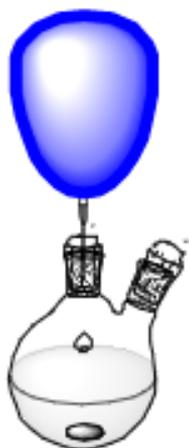
**Figura 8.-** Montaje llevado a cabo en las etapas de hinchamiento y anclaje, sea convencional o con modificaciones, con el fin de garantizar atmósfera inerte en el interior del recipiente.
