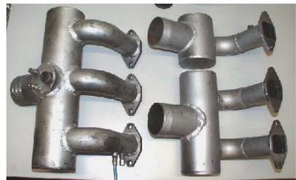
Figura 2. 13: Piezas utilizadas para el colector de admisión utilizado para ensayar turbogrupos.
