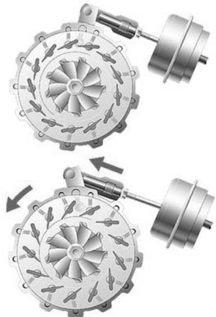
*Figura 4. 7: Mecanismo de variación del área de paso de los gases en el estator variando la posición relativa de los álabes. En la figura de arriba la turbina está "cerrada" y en la de abajo está "abierta".*
