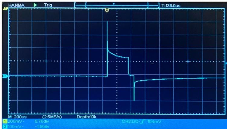
Figura 17: Imagen de la señal del pulso creado por un estimulador con generador de voltaje (abscisa: tiempo y ordenada: voltaje, unidades arbitrarias)
