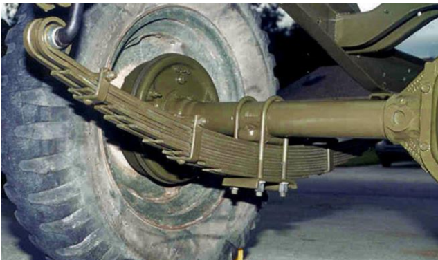
Abbildung 5: Blattfeder eines Fahrzeuges
